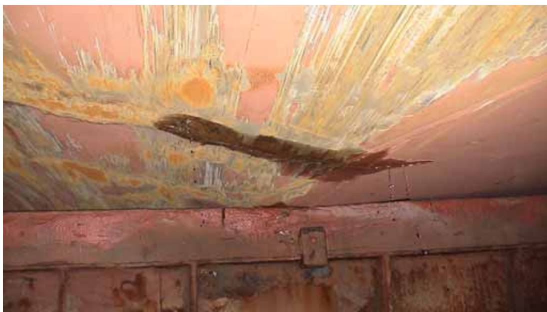
Kuva 7. Lievä repeämä painolastitankissa.
