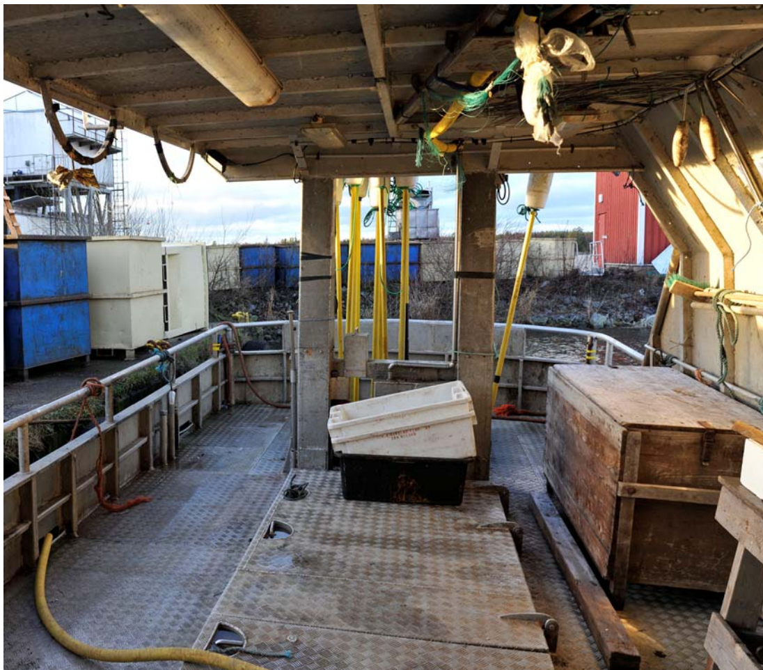
Bild 2. MASI:s akterdäck från vilket näten släpps ut över akterräcket. Akterräckets höjd från däcket var ca 85 cm (bilden är tagen under den nya ägarens tid).
