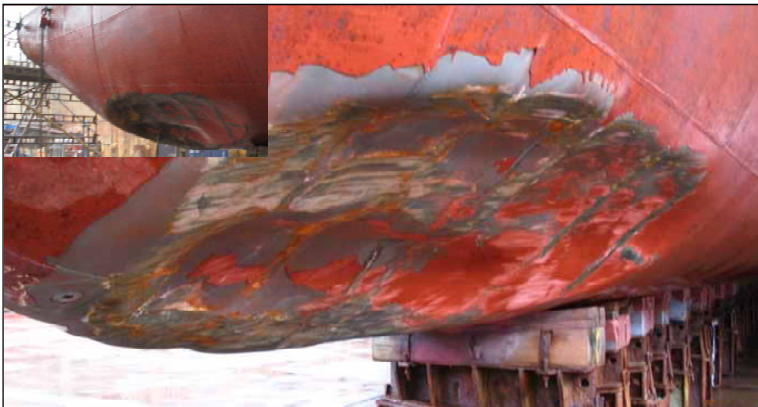
Kuva 14. MS TALin pohjan painauma lähellä potkuria ja peräsintä. Aluksen pohjassa ei ollut muualla vaurioita.
