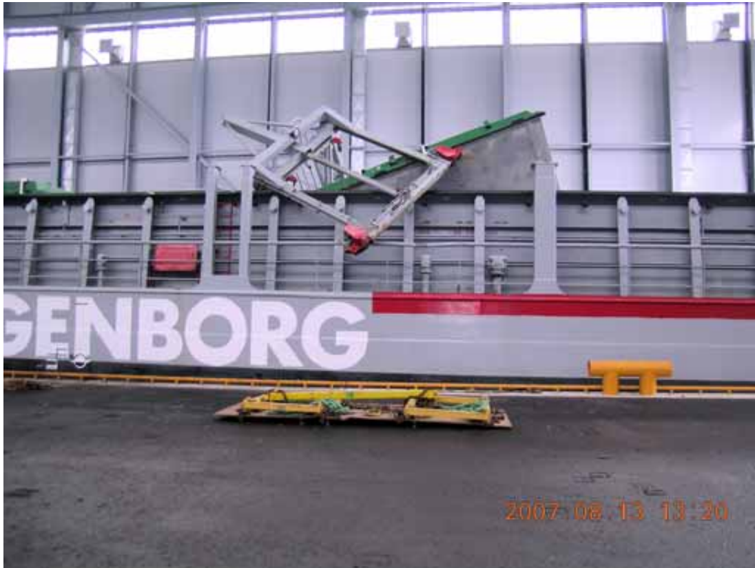
Kuva 3. MS GRACHTBORGin kaatunut kansiluukkunosturi.
