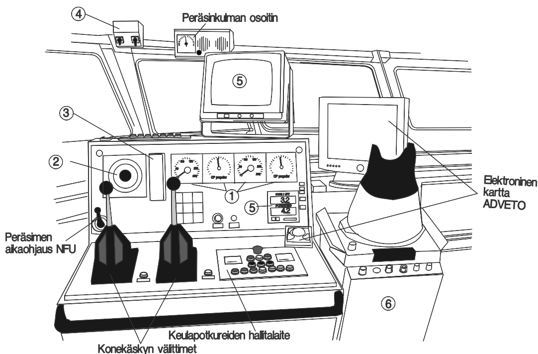
Bild 8. Texterna i bilden pekar på de system som behövs i hamnmanövrering.
