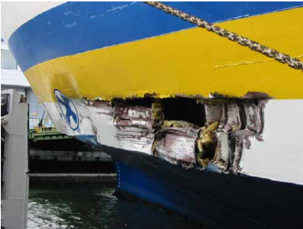
Bild 20. NORDLANDIAs skada i fören av fartyget på babords sida. Skadan uppstod som följd av kollisionen med kajens fendert. I bilden till vänster syns också den dämpande delen av en likadan men hel fendert.
