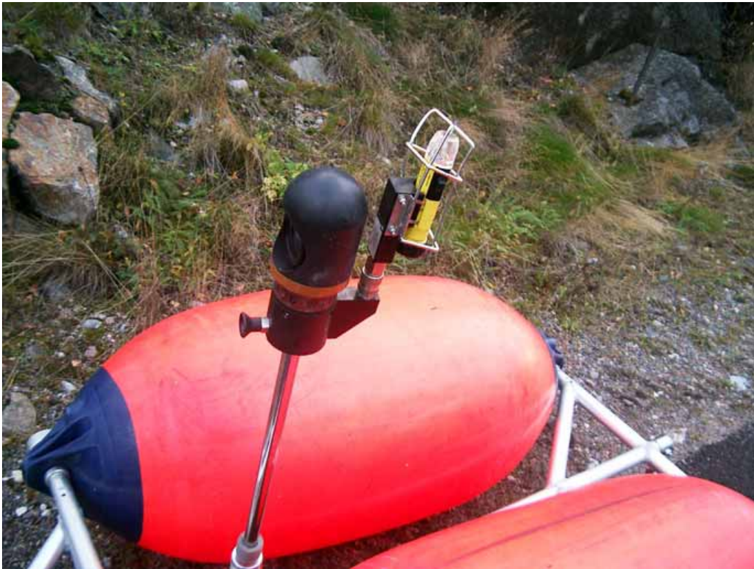
Bild 3. Bojen som bogseras i kölvattnet med ett blinkande ljus, som syns runt synfältet.
