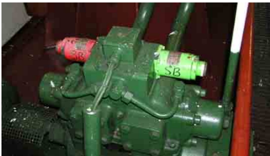
Bild 4. Rodermaskinens hydraulikpump. På gröna knappen svänger rodret till styrbord och på röda till babord.
