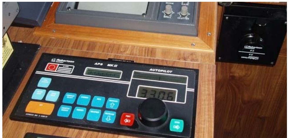
Styranordningen på KBV 046. Uppe till höger i bild syns handstyrningsspaken.
