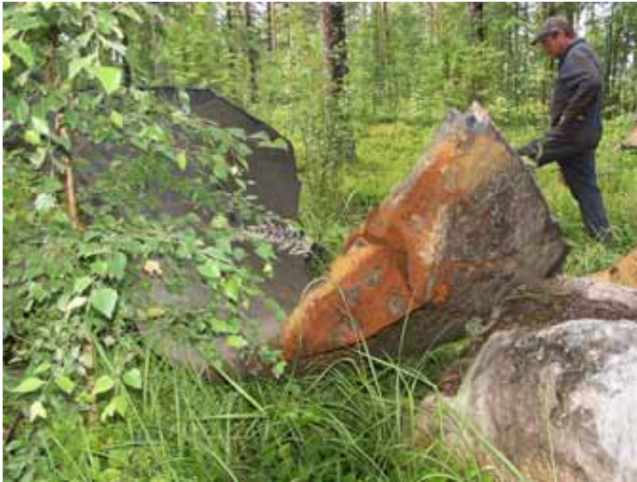
Kuva 11. Suulake irrotettuna aluksesta. Johtoreunan alaosa on kärsinyt eniten koko aluksessa.
