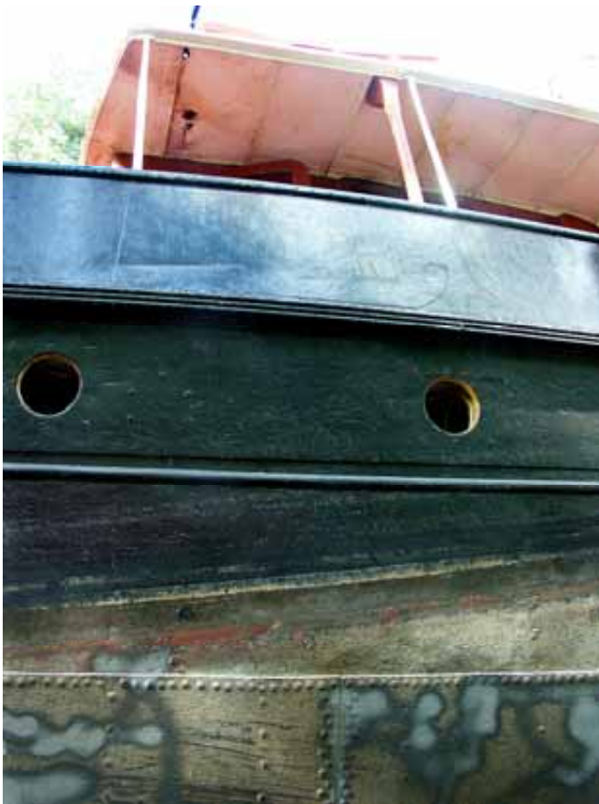
Kuva 15. Laidassa olevat valoventtiilit
