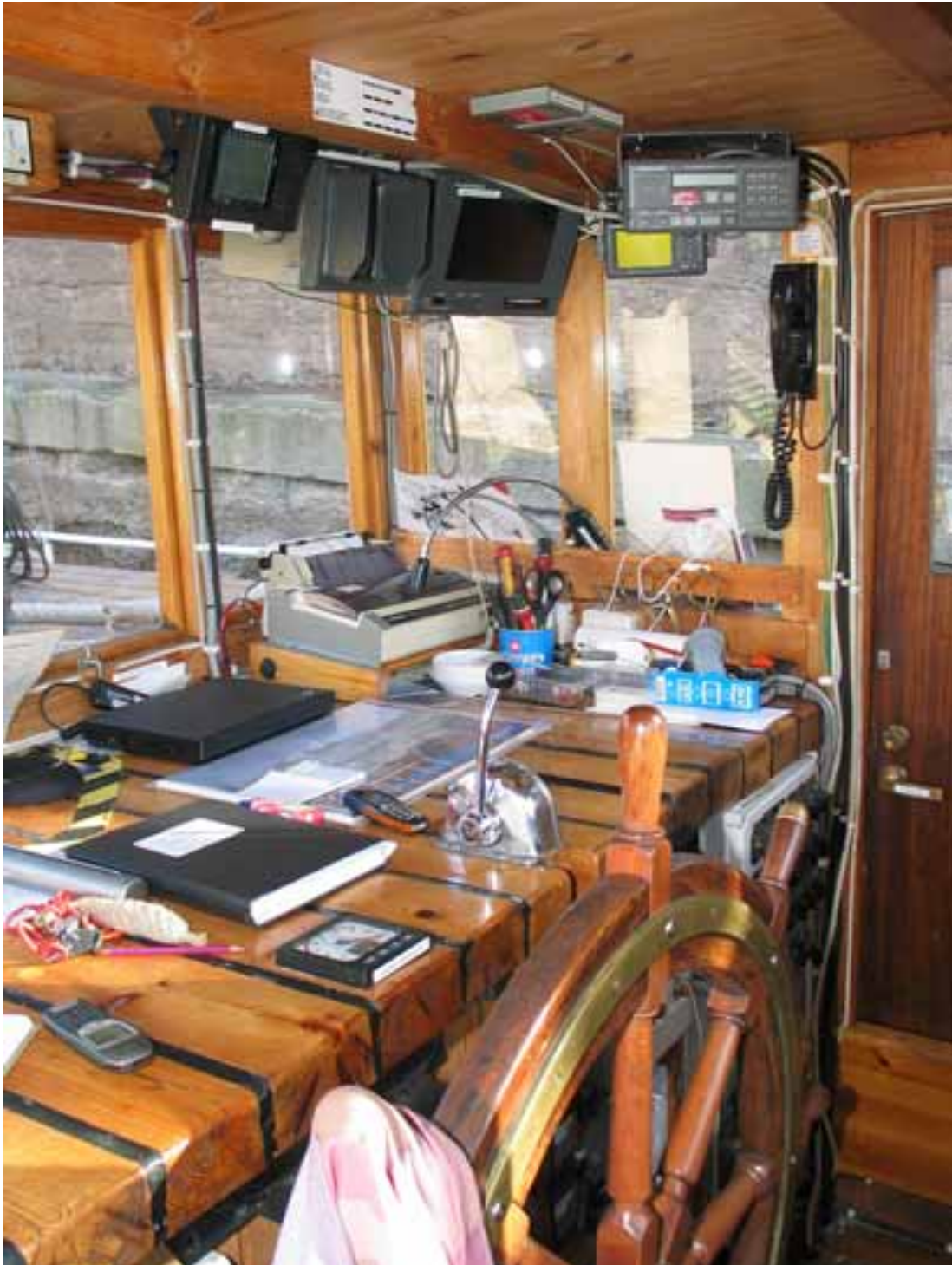
Kuva 4. Karttapöydän oikeassa kulmassa on printteri. Sen vasemmalla puolella on kannettava tietokone, jossa oli elektroninen kartta.
