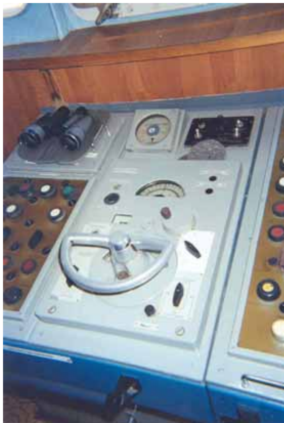
Kuva 5. Kuvassa vasemmanpuoleinen keskikonsolin ruoreista ja sen edessä peräsinkulmanosoitin.
