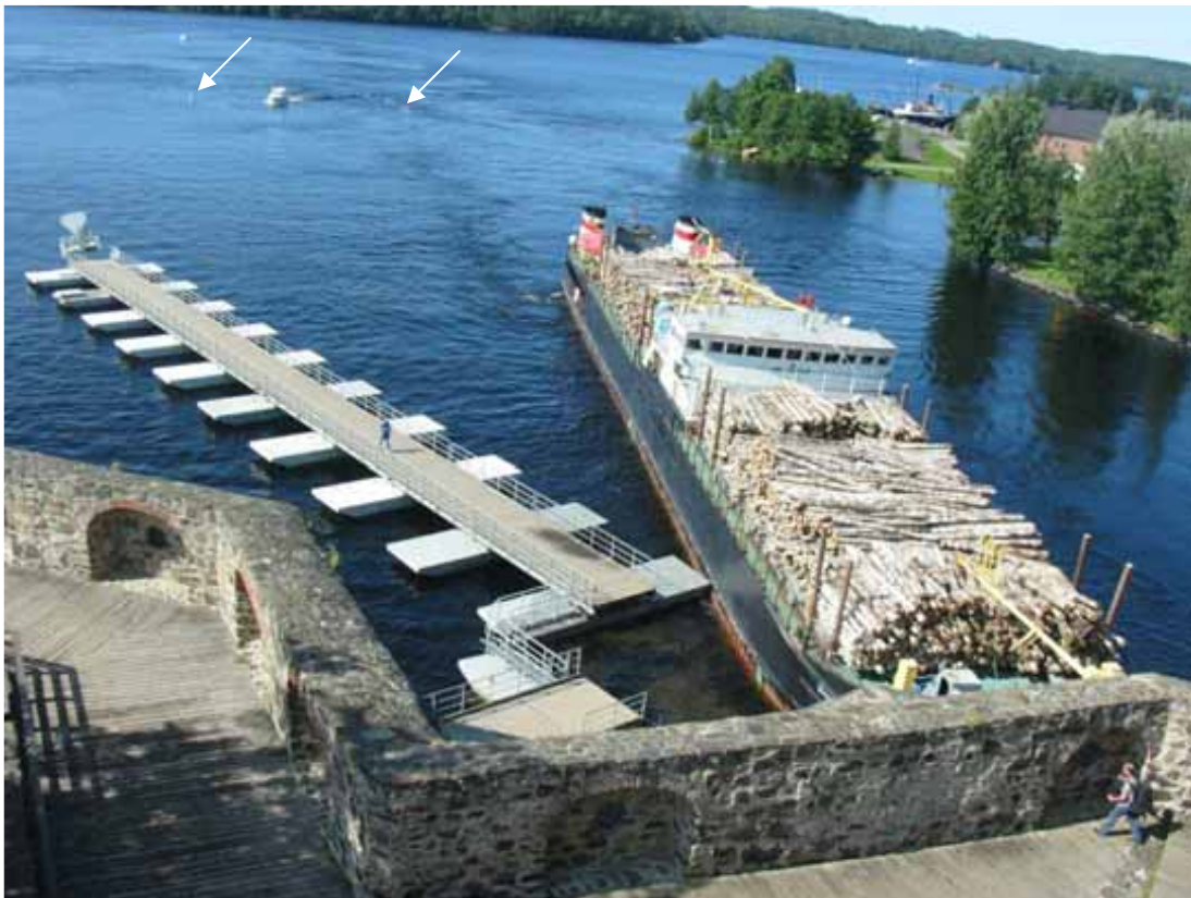
Kuva 23. KRASNOVIDOVO kuvattuna pian törmäämisen jälkeen (klo 10:37:56). Alus nojaa ponttonisiltaan törmäyskohdasta. Kuvasta näkyy myös sillan kiinteän osan siirtymä kiinnityksen irrottua. (Sillan osittain näkyvän kiinteän osan kannen tulisi olla melko tarkkaan kuvassa etualalla olevan vaakasuuntaisen muurin suuntainen.) Sillan vapaassa päässä on näkyvissä vaurioitunut merimerkki. Kuvassa näkyy myös valkoisilla nuolilla merkitty puna-vihreä viitta- pari, jonka kohdalla on valkoinen moottorivene. Punainen viitta on lähes kokonaan veden alla. (© Timo Härkönen)
