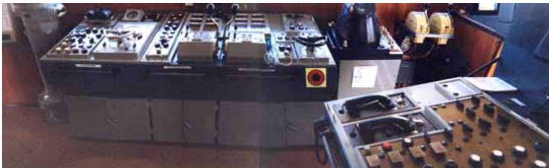
Kuva 6. Keskikonsoli, jossa on kaksi peräsinten käsiohjauspaikkaa konsolin päissä. Kuvan 5 ruori on konsolin vasemmassa reunassa.
