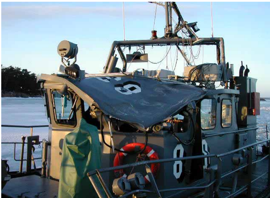
Bild 4. HÖGSÅRAS styrhytt efter kollisionen
