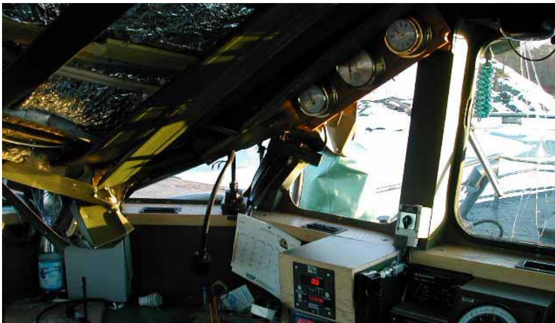
Bild 5. HÖGSÅRAS styrhytt sedd inifrån efter kollisionen
