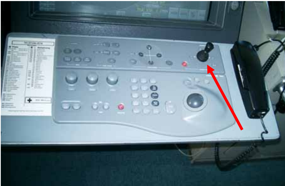
Bild 6. Befälhavarens manöverpanel, pilen visar override tiller.
