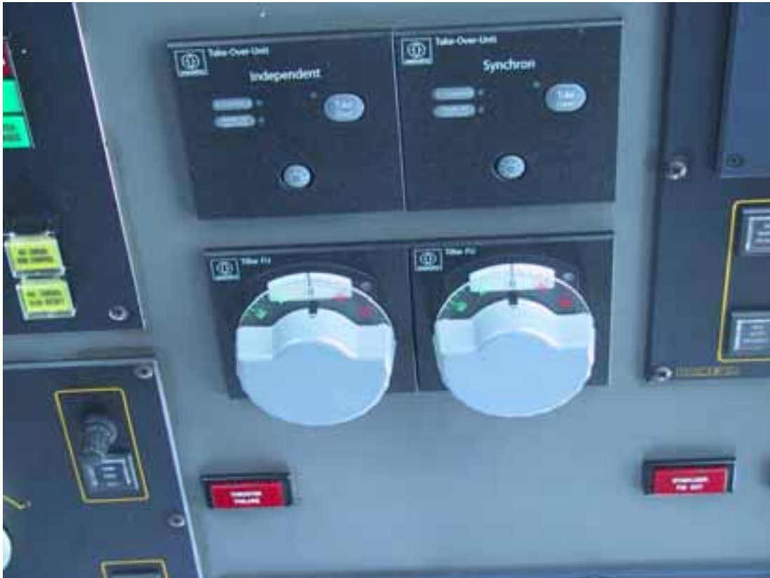
Kuva 8. Peräsinten Follow Up -ohjaus komentosillan siivillä.
