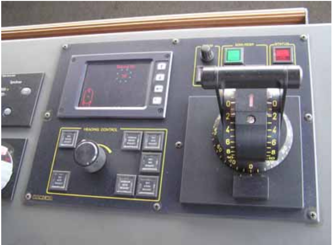
Kuva 9. Satamaohjailun kannalta tehokas KaMeWa Joystick.
