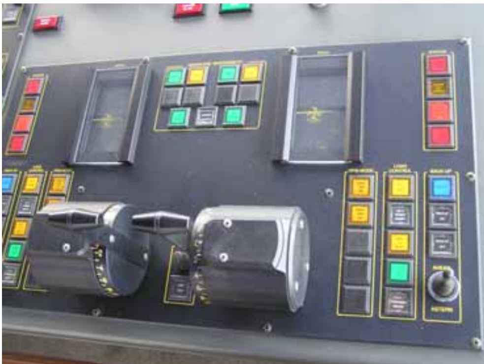
Kuva 5. Päällikön käyttämät pääpotkureiden hallintavivut.
