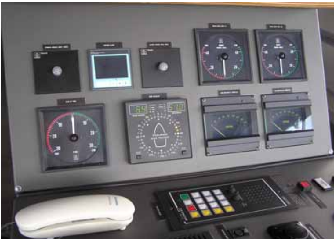
Kuva 6. Mittaripaneeli komentosillan siivellä. Mittarit ovat ylhäältä vasemmalle konsolin valojen himmentimet, laiturointihälytys, peräsinkulman mittareiden himmennin ja peräsinkulman mittarit. Alhaalla vasemmalta oikealle ovat kulmanopeusmittari, tuulimittari ja pää potkureiden kierrosluvut.
