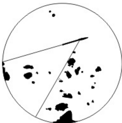
Bild 6. Bäringen till randmärket visar stället där svängen påbörjades. Radarn visar inte avdriften, d.v.s. fartygets rörelse i förhållande till havsbotten.
