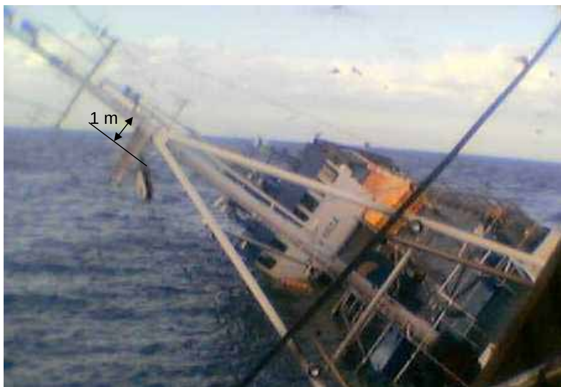
Bild 7. SEA GULL fotograferad 27.5.2004 på morgonen ca kl. 5. Fartyget hade då en slagsida på ca 55 grader. Lyftets stödpunkt är ca 1 m till sidan om centerlinjen.
