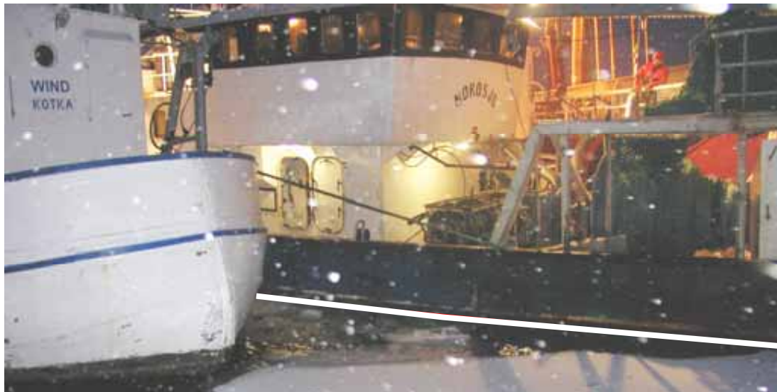
Bild 4. NORDSJÖ förtöjd vid WIND på morgonen 27.1.2004. Dörrarna till akterbyggnaden och backen är öppna. Fartygets djupgående ser ut att nå ända till huvuddäcket (den uppskattade vattenlinjen utmärkt med en vit linje). Fartygets slagsida har antagligen nästan rätats upp.
