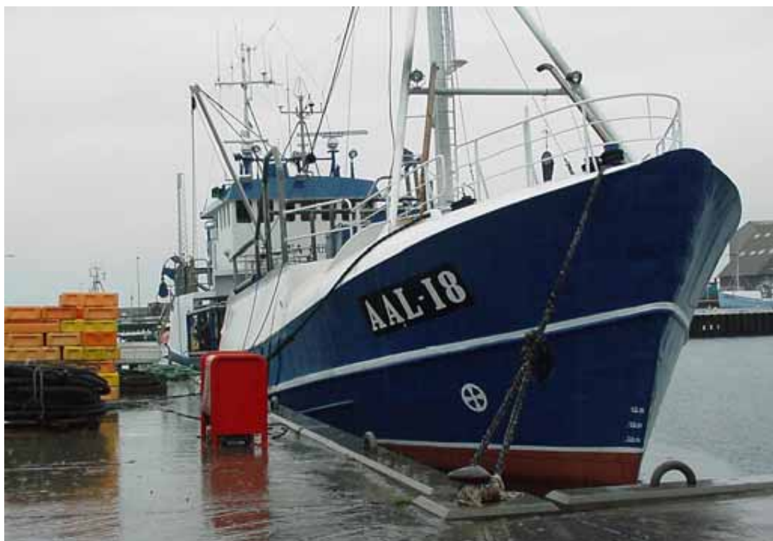
Bild 3. SEA GULLs styrbordssida. Åmningarna fr.o.m. 2,8 meter kan ses i bilden. Märket för bogpropellern syns tydligt.
