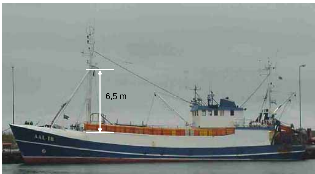
Bild 2. SEA GULL På bilden kan man se fartygets vänstra sida. Fartyget var till sin struktur osymmetriskt, jämför med bild 3 och skissen över generalplanen, bild 9. Vid lyftet av fiskpåsen var påsens stödpunkt på ca 6,5 m höjd från backens däck. I bild 7 syns stödpunkten från sidan. Vid lyftet krängde fartyget mot styrbord. På bilden är fartygets djupgående ca 2 m i fören och 2,7 m i aktern. I bilden syns också märket för bogpropellern.
