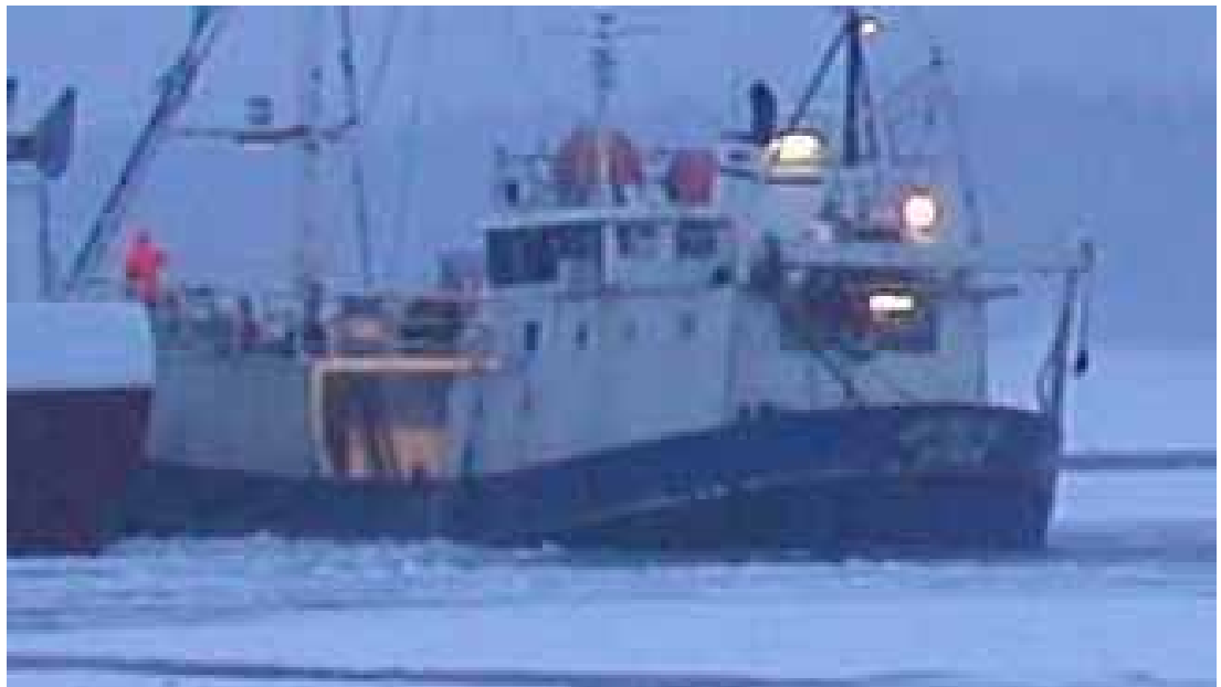
Bild 13. Bedömningen av NORDSJÖs ställning under tömningen. Aktern ligger högt, dvs. fartyget har ett tämligen stort förtrim. Djupgåendet är ännu närmare 3,5 meter. Fartyget har antagligen fortfarande en liten slagsida mot styrbord.
