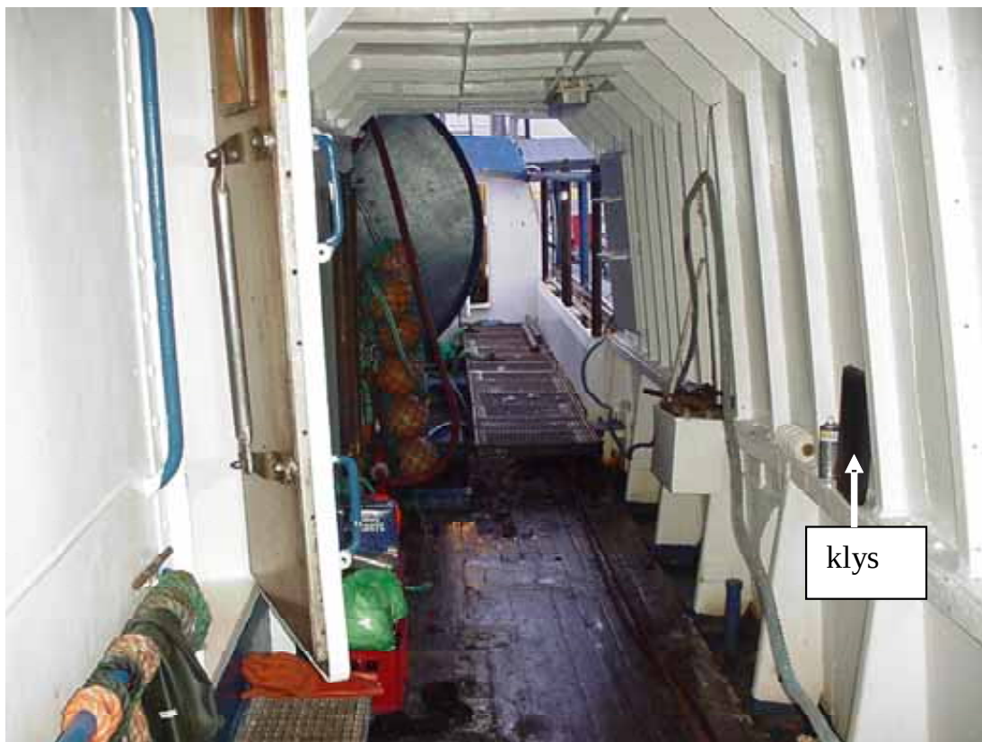
Bild 4. Korridoren på SEA GULLs styrbordssida. Dörrarna och trösklarna som leder till däcksoverbyggnaden kan ses i bilden. Det finns en fönsterventil i dörren till däcksoverbyggnaden. Klysen till höger.
