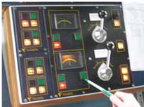
Kuva 11. Kynä osoittaa keulapotkurin aktiivoinnin "In Command" näppäintä.
