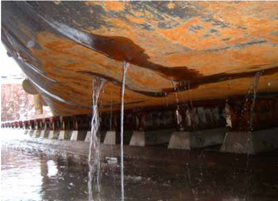
Bild 5. Skador på BIANCAs skrov fotograferade i dockan i Mariehamn.
