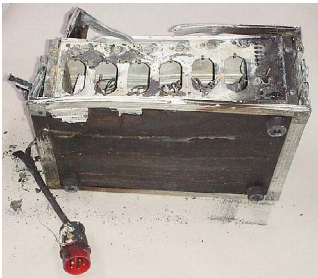
Bild 4. Dimmern (en s.k. ljusorgel) som förorsakade branden (botten och frampanelen).
