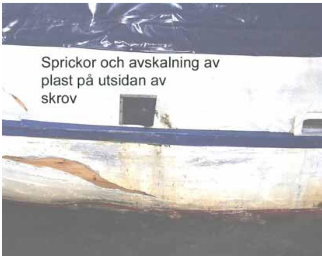
Bild 3. Skador i SARAs babord utsida.
