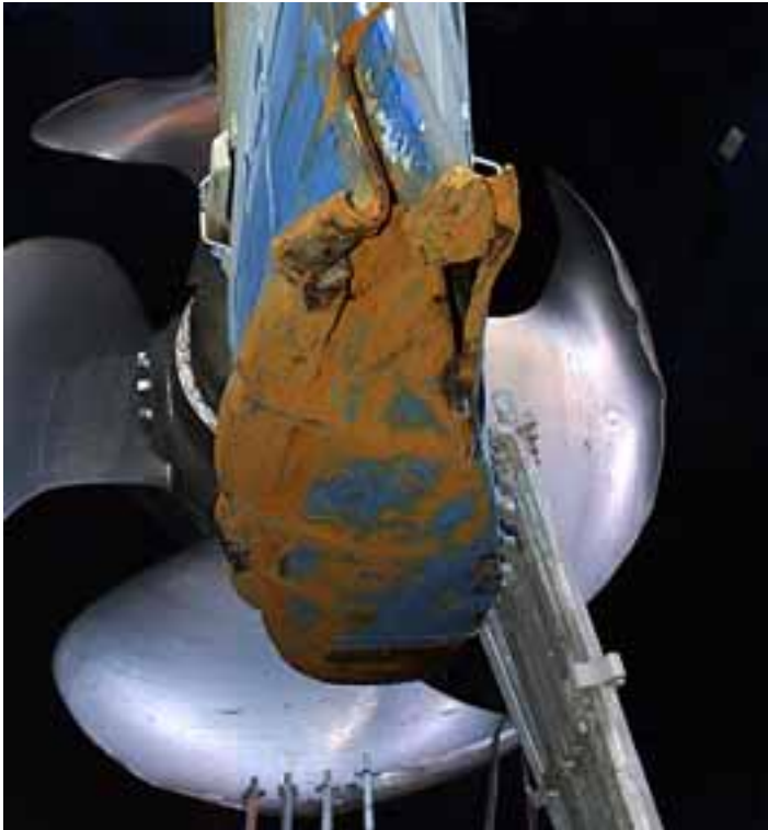
Fig. 21. Skador på propellern och rodret.
