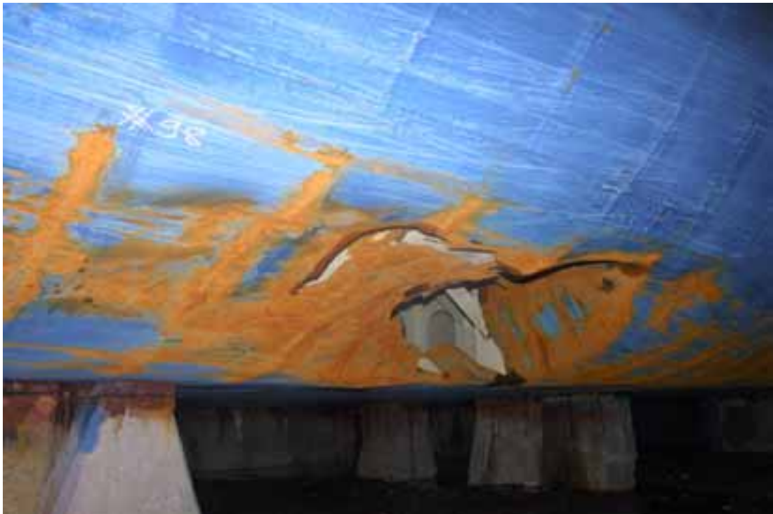
Fig. 19. Det stora hålet som revs upp midskepps.
