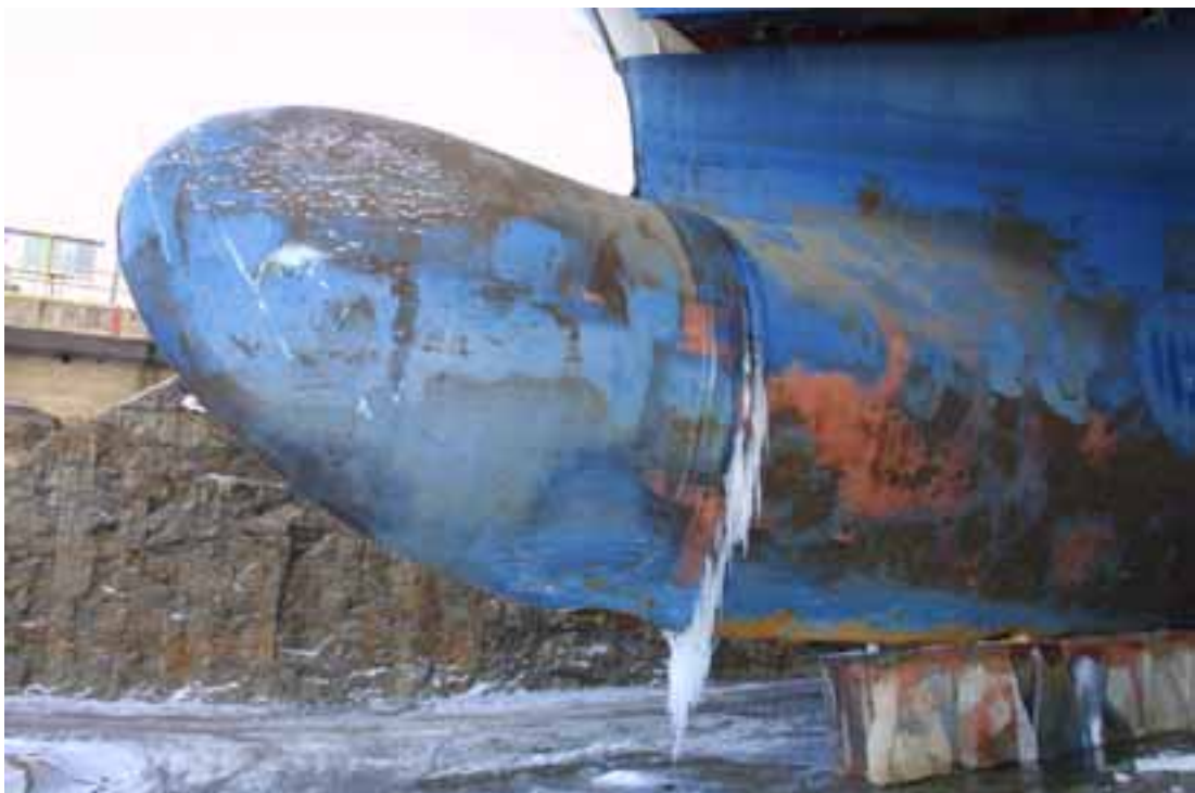
Fig. 20. Ett stycke lossnade från bulbens nedre kant.
