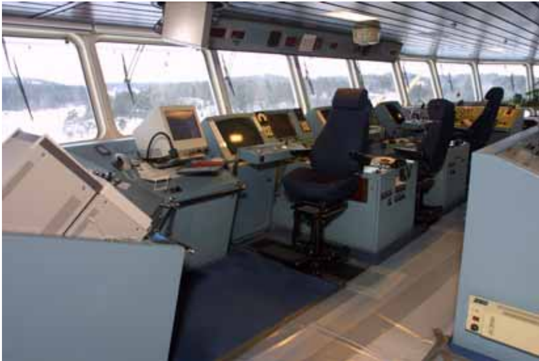
Fig. 3. ISABELLAs kommandobrygga; närmast kameran linjelotsens, därefter vaktchefens och längst bort lotsinspektörens stolar.
