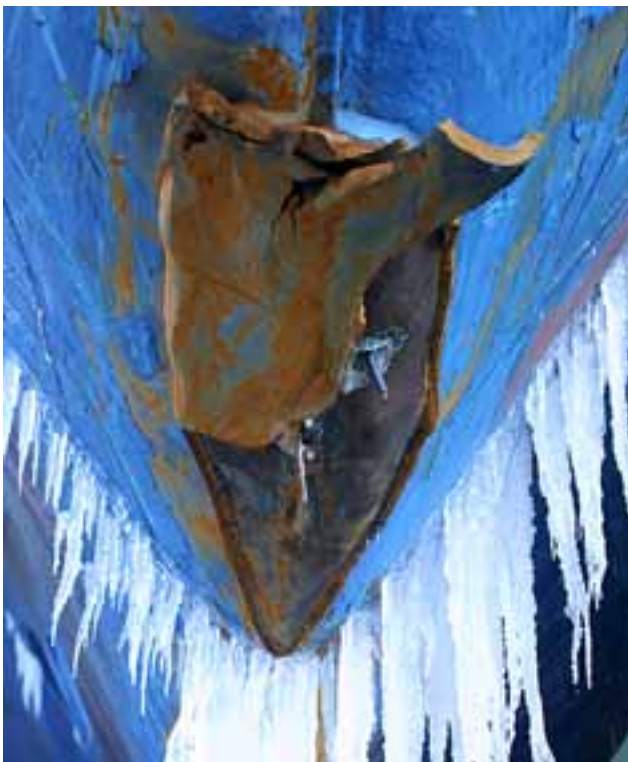
Fig. 22. Givarna i instrumentbulben demolerades.
