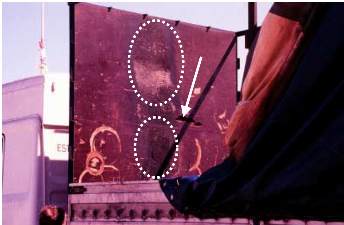
Bild 3c. Två, ganska små, områden som förkolnat kan ses på släpvagnens främre vägg (innanför de streckade linjerna). På det ställe pilen pekar på finns ett litet hål.
