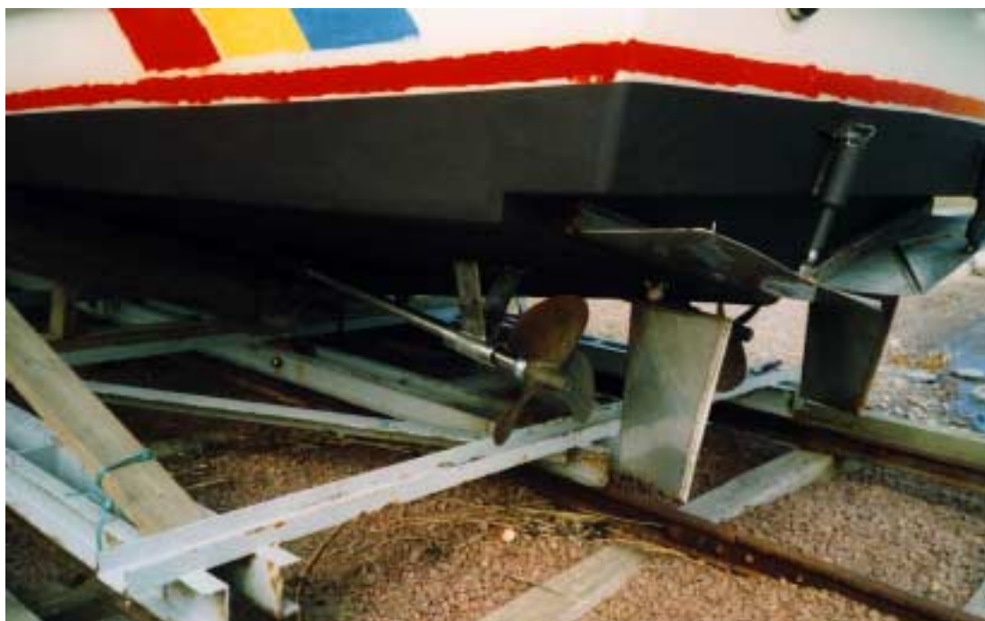
Bild 17. ALBATROSSENS propellrar och roder.
