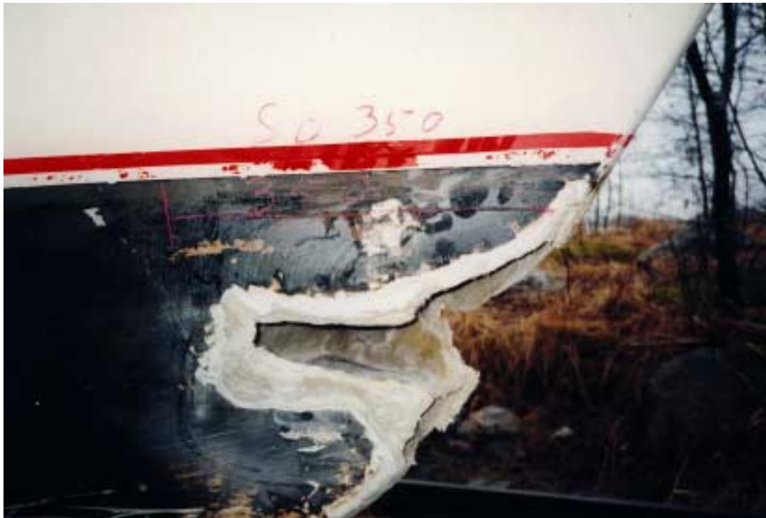
Bild 12b. Isskadan i stäven på ALBATROSSEN, styrbordssidan
