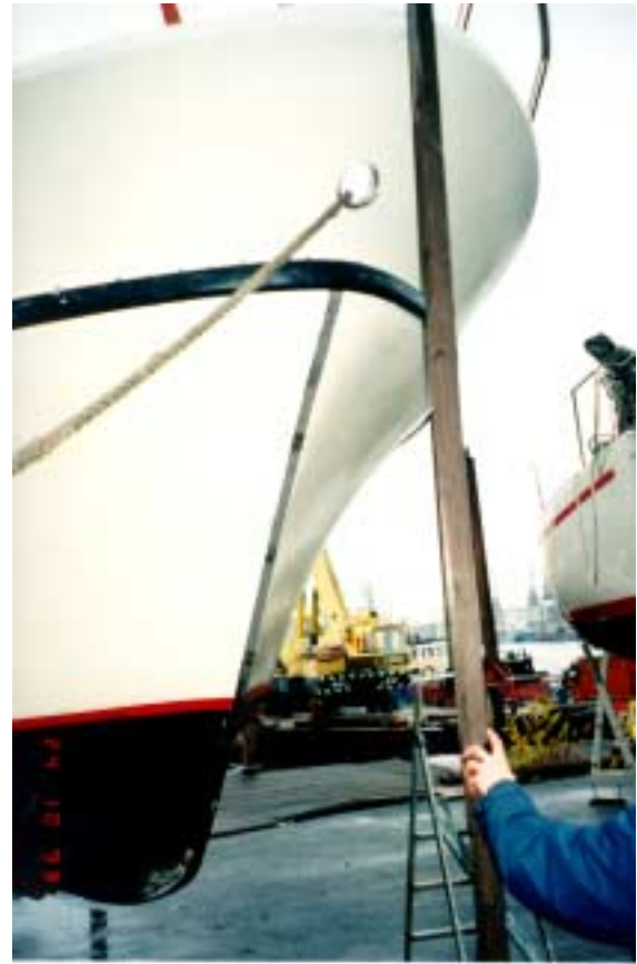
Bild 11. ALBATROSSENS för. Stävskenan som syns på förstäven har installerats efter haveriet.
