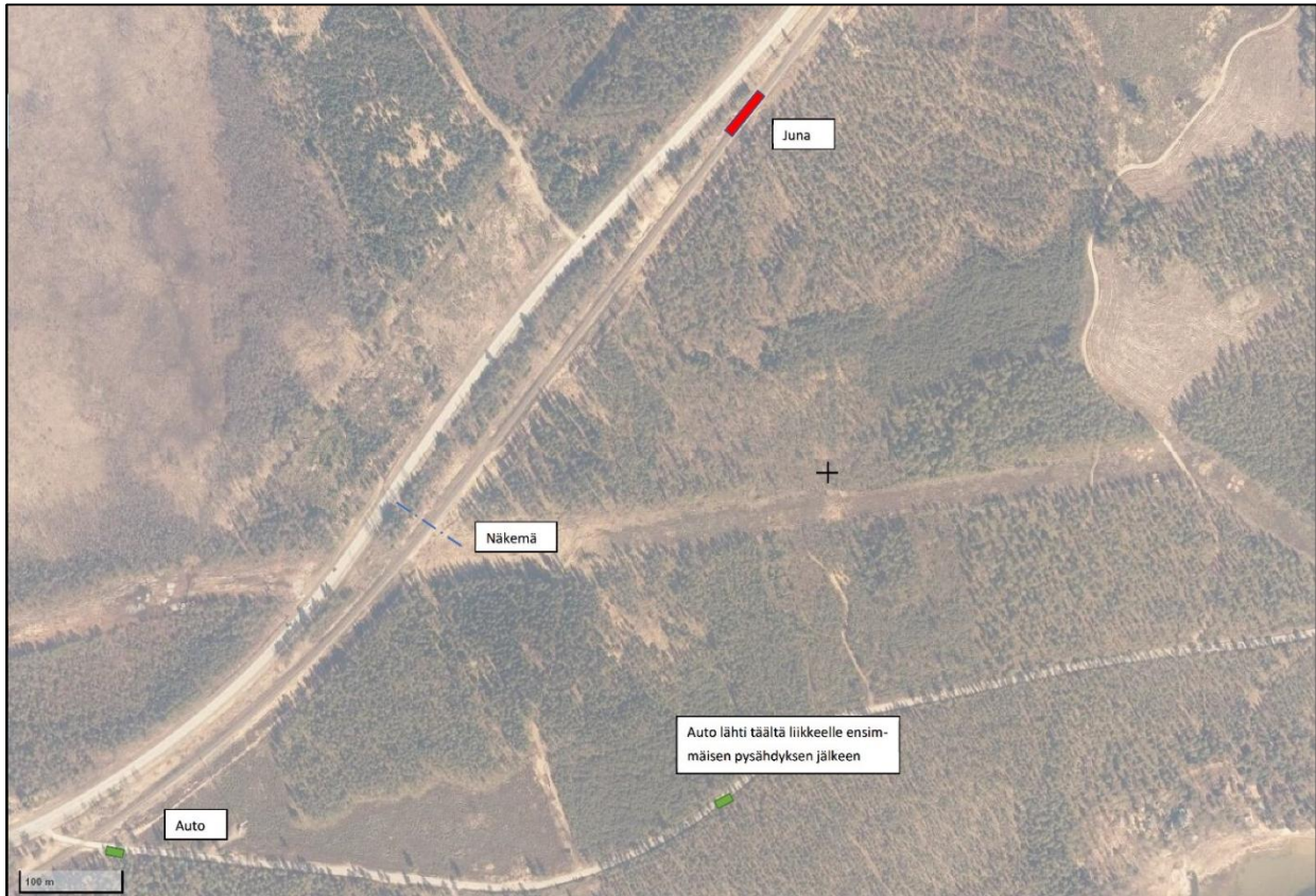
Bild 19. 31 sekunder före kollisionen stannade bilen på 30 meters avstånd från banan, medan tåget närmade sig plankorsningen från 960 meters avstånd med en hastighet på 111 km/h. På bilden anges också frisiktsområdet mot tågets färdriktning (437 m från plankorsningen) och platsen från vilken bilden startade 645 m från plankorsningen, då tåget befann sig 4 km 480 m från plankorsningen med en hastighet på 119 km/h. (Baskarta: Ortofoto ©Lantmäteriverket 1/2014, märkningar: OTKES)
