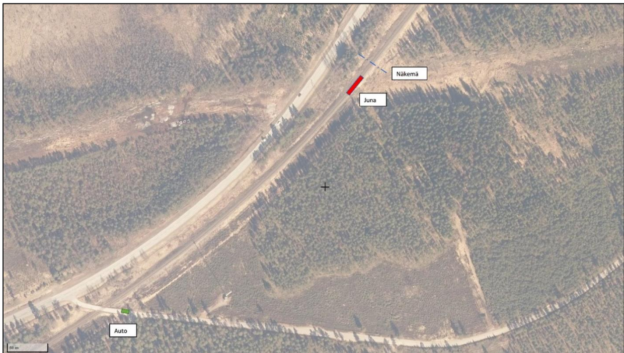
Bild 20. 13 sekunder före kollisionen började bilen köra framåt 30 meter från banan, medan tåget närmade sig plankorsningen från 400 meters avstånd med en hastighet på 112 km/h. På bilden anges också frisiktsområdet mot tågets färdriktning (437 m från plankorsningen). (Baskarta: Ortofoto ©Lantmäteriverket 1/2014, märkningar: OTKES)
