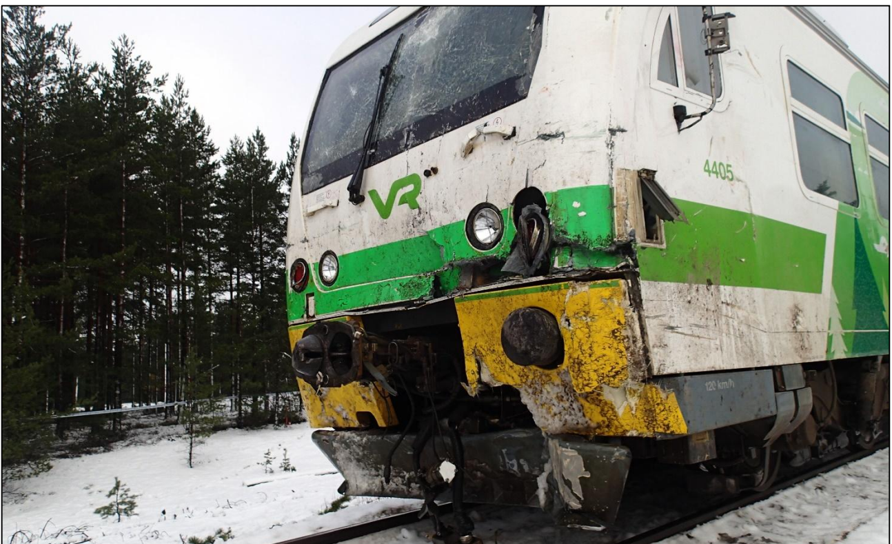
Bild 9. Skador på rälsbussens framsida. (Bild: OTKES)
