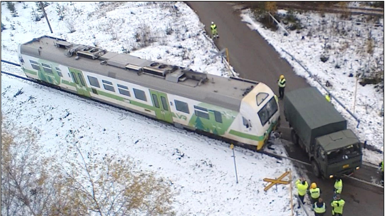
Bild 2. Rålsbussens vänstra framparti träffade terränglastbilens högra bakhjul. Bild av rekonstruktion på olycksplatsen. (Bild: OTKES)
