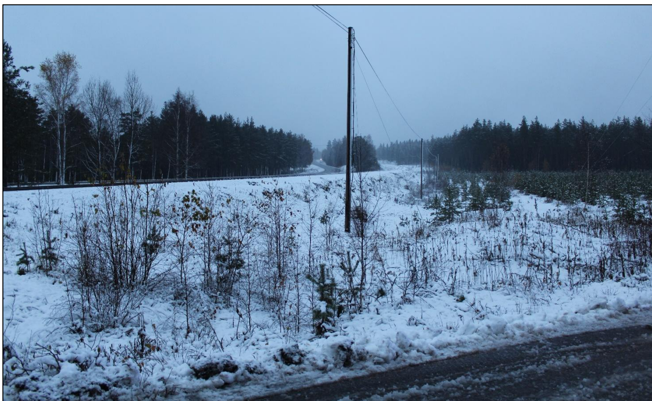
Bild 16. Frisiktsområdet mot höger när man närmar sig Skogby plankorsning från öster. Tågbanan och riksväg 25 kan blandas ihop. Fotot har tagits ca 20 minuter efter olyckan. Landskapet ser disigt ut på längre avstånd. Vid olyckstidpunkten var det dunklare och det regnade snöblandat regn. (Bild: Västra Nylands räddningsverk)
