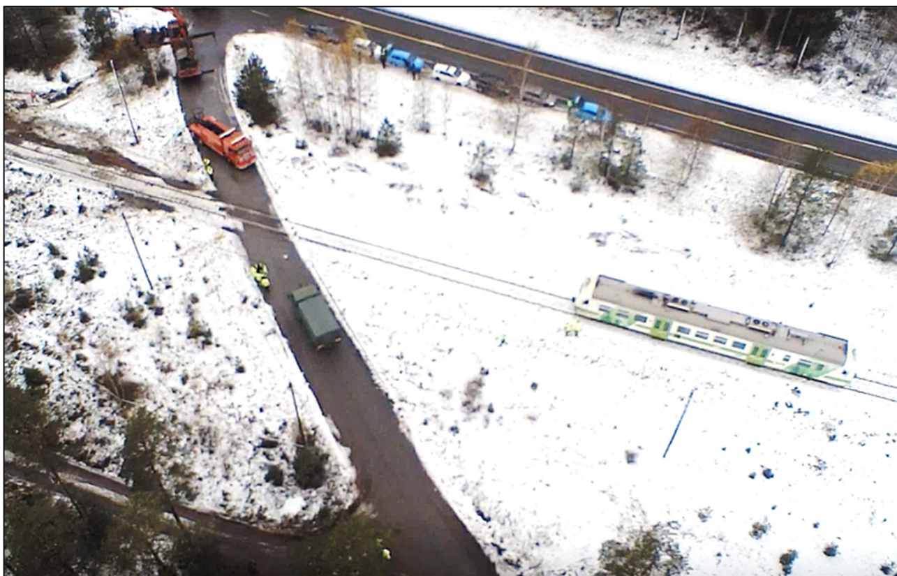
Bild 14. Före olyckan närmade sig rälsbussen terränglastbilen snett bakifrån på grund av plankorsningens vinkel. Bild av rekonstruktionen. (Bild: OTKES)
