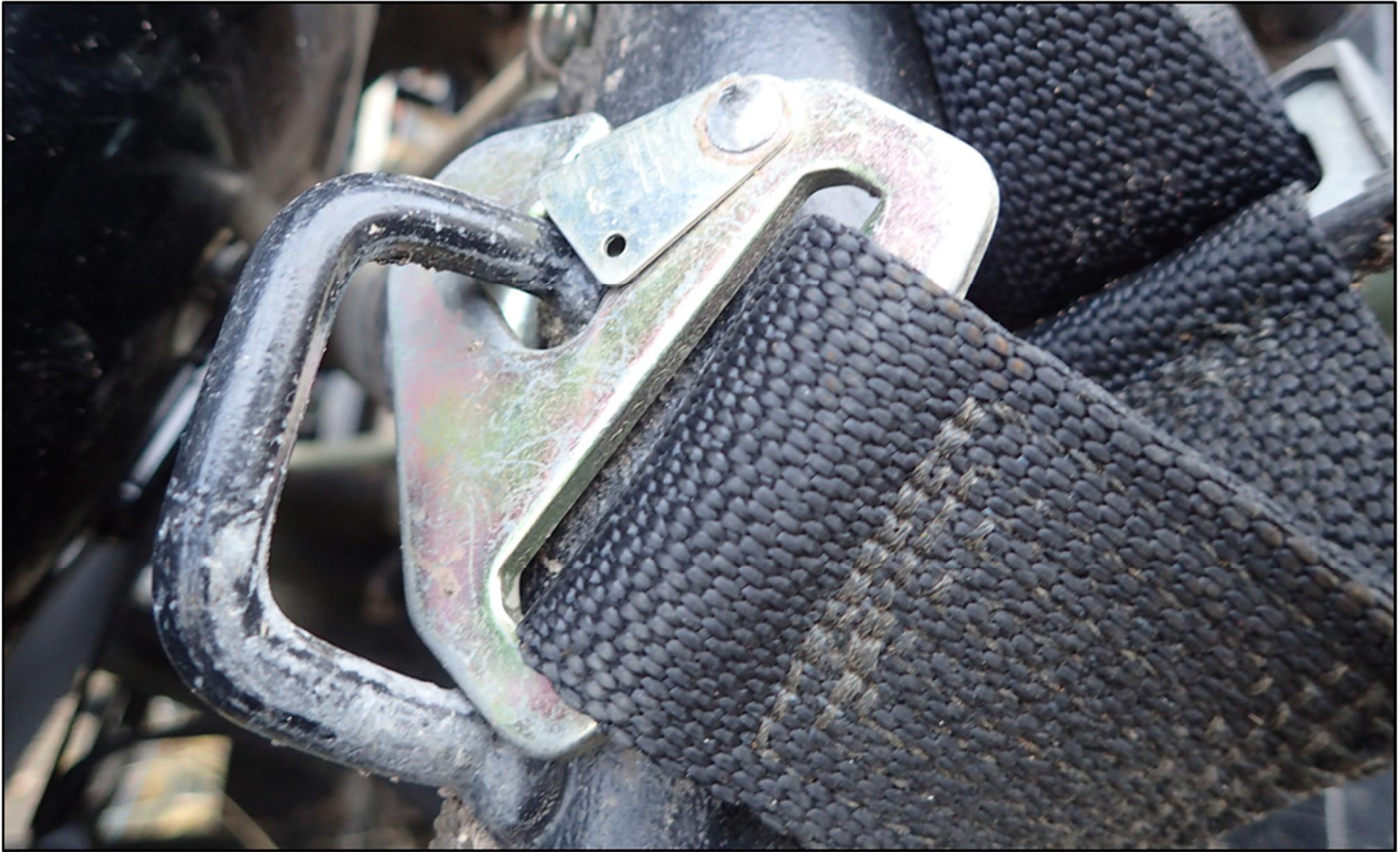
Bild 12. Fästdonen för säkerhetsbältena för sätesmodulerna på terränglastbilen inspekterades och konstaterades vara i skick. (Bild: OTKES)
