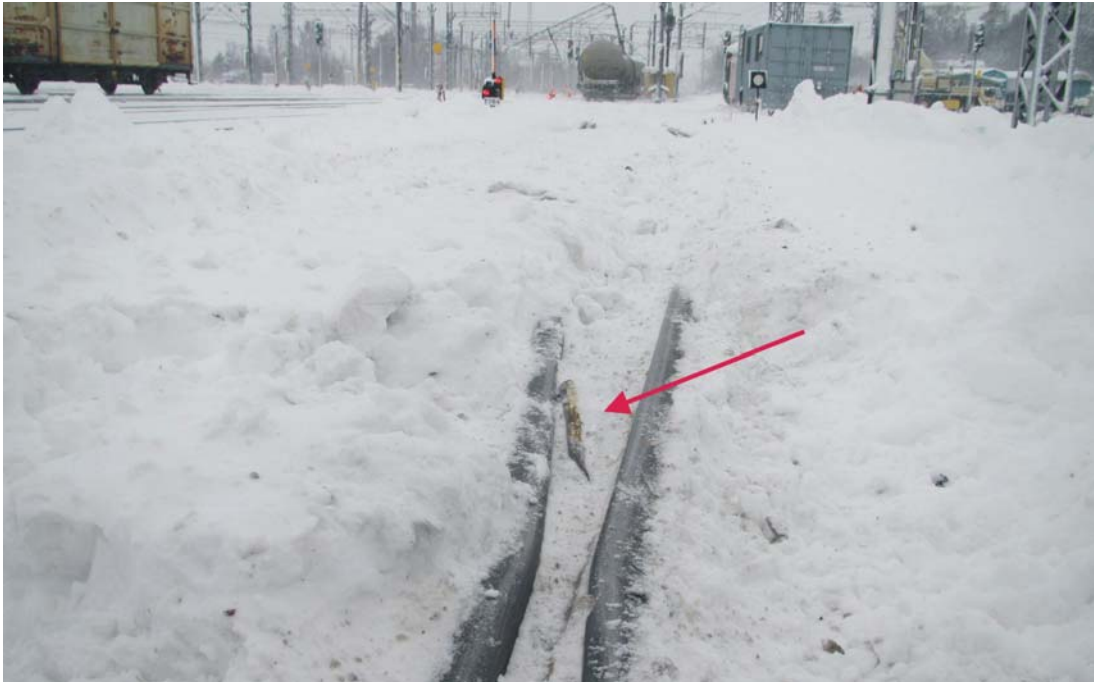
Kuva 4. Vaihteen risteyksen kiskojen välistä löytyi lumeen hautautunut pysäytyskenkä.
