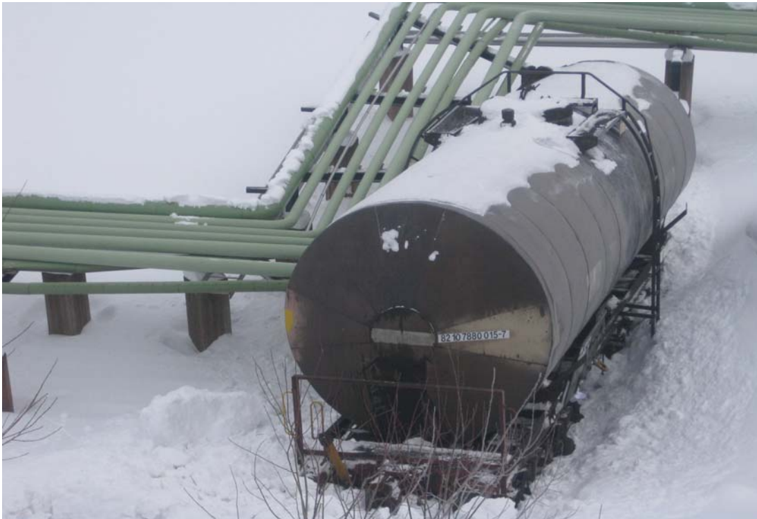
Kuva 5. Ensimmäisenä ollut suojavaunu kulki penkerettä alas ja pysähtyi kaasulinjaan.
