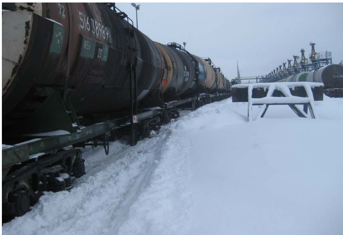
Kuva 4. Kuvassa vasemmalla näkyvä venäläinen säiliövaunu oli neljäs suistunut vaunu. Raiteen päässä ollut raidepuskin sijaitsi kuvassa kolmantena olevan vaunun kohdalla.
