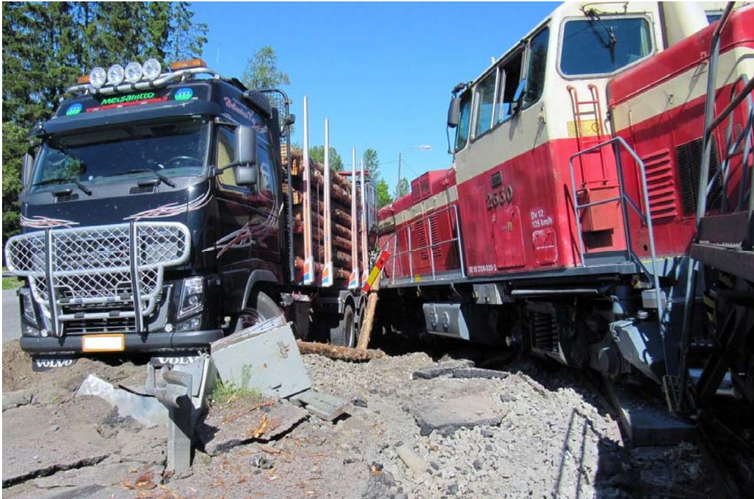
Kuva 3. Juna työnsi ajoneuvoyhdistelmää edellään 25 metriä ja molemmat veturit suitsuivat kiskoilta. Ajoneuvoyhdistelmä rikkoi tasoristeyksen puolipuomilaitoksen puomin ja kevyenliikenteenväylän puomilaitteiston (kuva poliisi).
