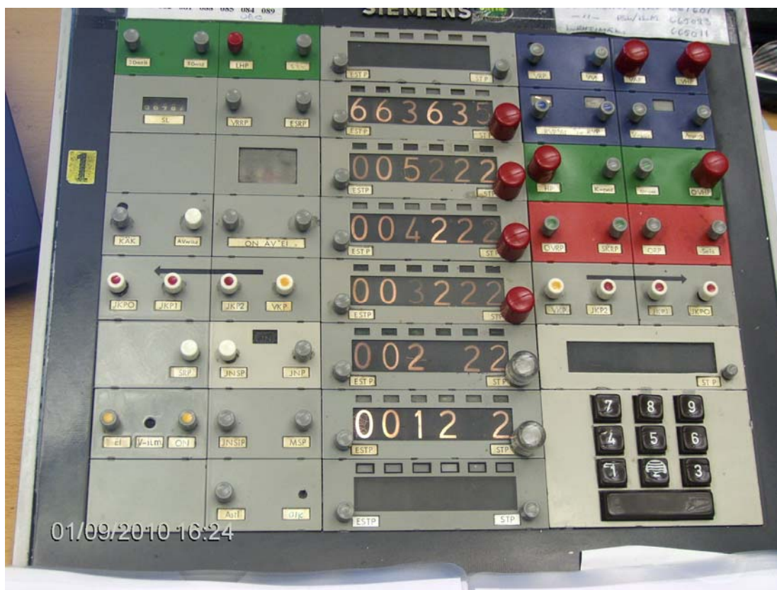
Kuva 7. Asetinlaitteen ohjauspöydän ohjaustaulu. Numeroilmaisimet ovat keskellä ja numeronäppäimistö on oikealla alhaalla. Ryhmä- ja apupainikkeita on numeroilmaisimien molemmin puolin.
