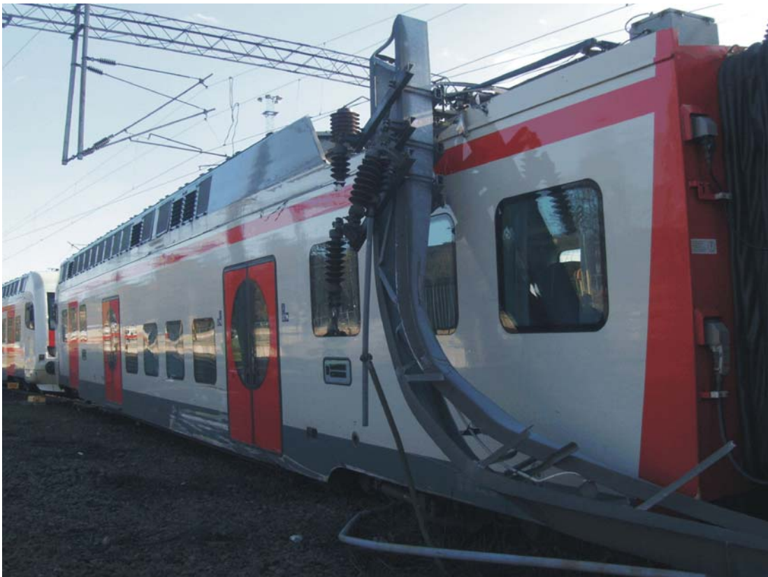
Kuva 3. Junan kylki törmäsi portaalipylvääseen.
