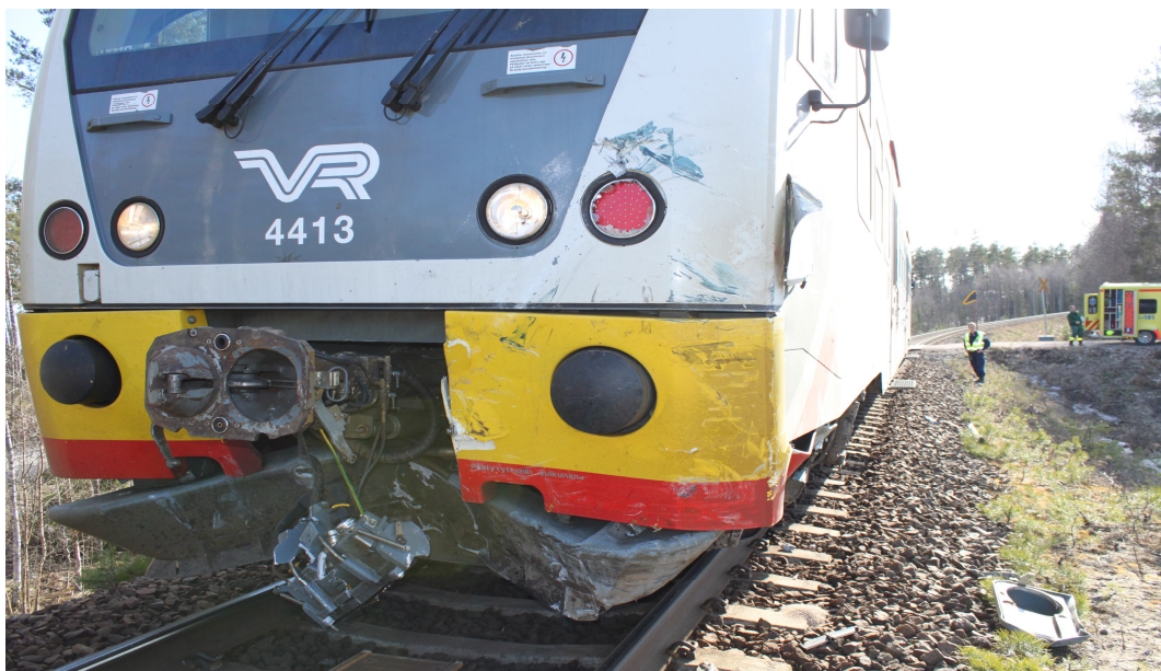
Kuva 3. Taajamajunan keula vaurioitui onnettomuudessa.
