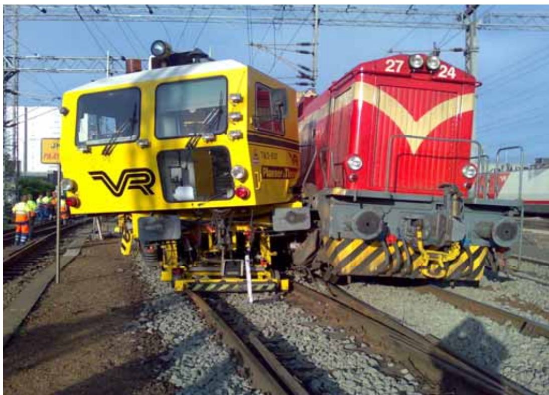
Kuva 3. Vaihteentukemiskone vaurioitui huomattavasti törmäyksessä.
