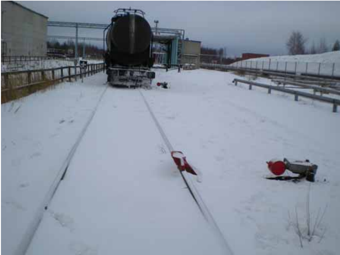
Kuva 2. Raiteen 044c raiteensulut suistumisen jälkeen. Kumpikin raiteensulku oli kiskolle käännetyssä asennossa.
