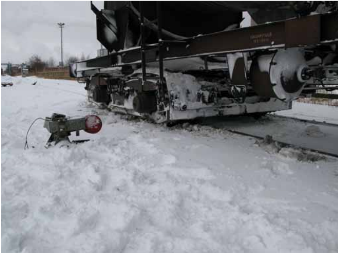
Kuva 3. Raiteensulku ja kiskoilta suistunut fosforihappovaunun teli.
