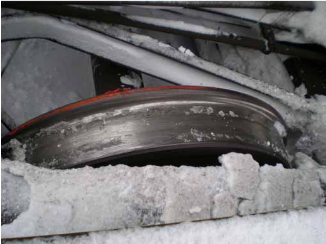
Kuva 4. Kuva raiteensulun suistamasta pyörästä. Kuvassa näkyy teliin kertynyt jää. Pyörän pinnalla ollut jää ei ole ehtinyt hävitä jarrutuksesta huolimatta.
