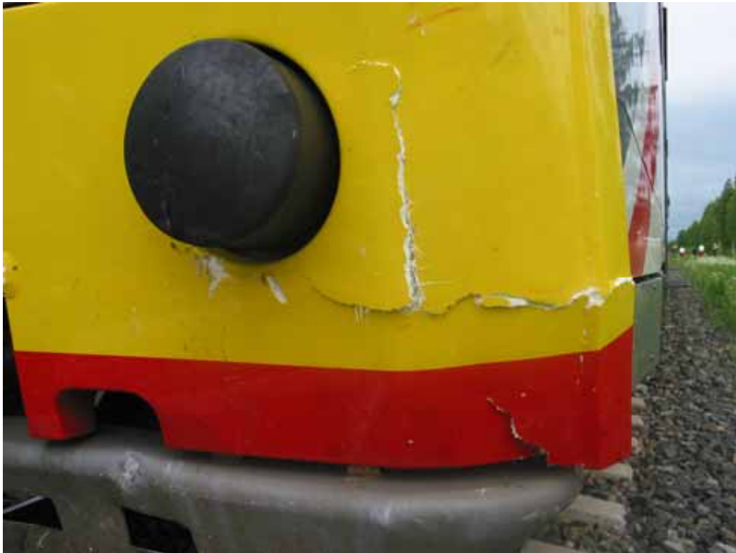
Kuva 2. Junan vasemman etukulman vauriot.
