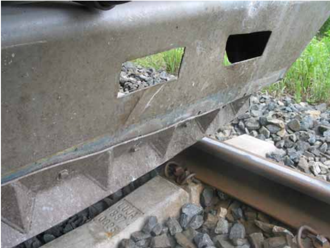
Kuva 3. Myös karja-auran alareuna irtosi osittain ruuvikiinnityksistään.
