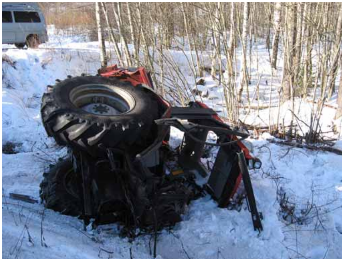
Kuva 3. Katkenneen traktorin takaosa ja turvaohjaamo (kuva: poliisi).
