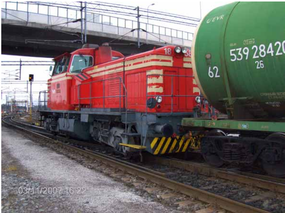
Kuva 3. Veturin etutelin ensimmäinen akseli suistui kiskoilta.
