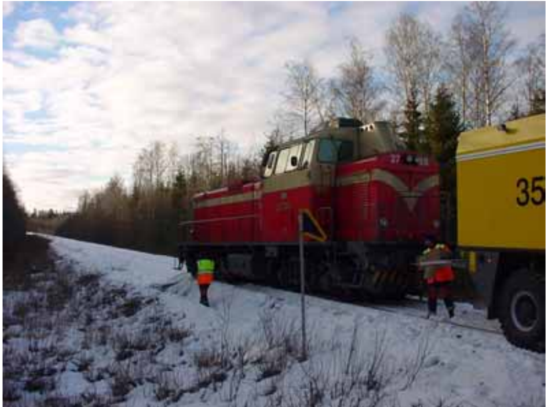
Kuva 2. Vaihtotyöyksikön suistunut veturi vaihtotyöyksikön kulkusuuntaan katsotuna.
