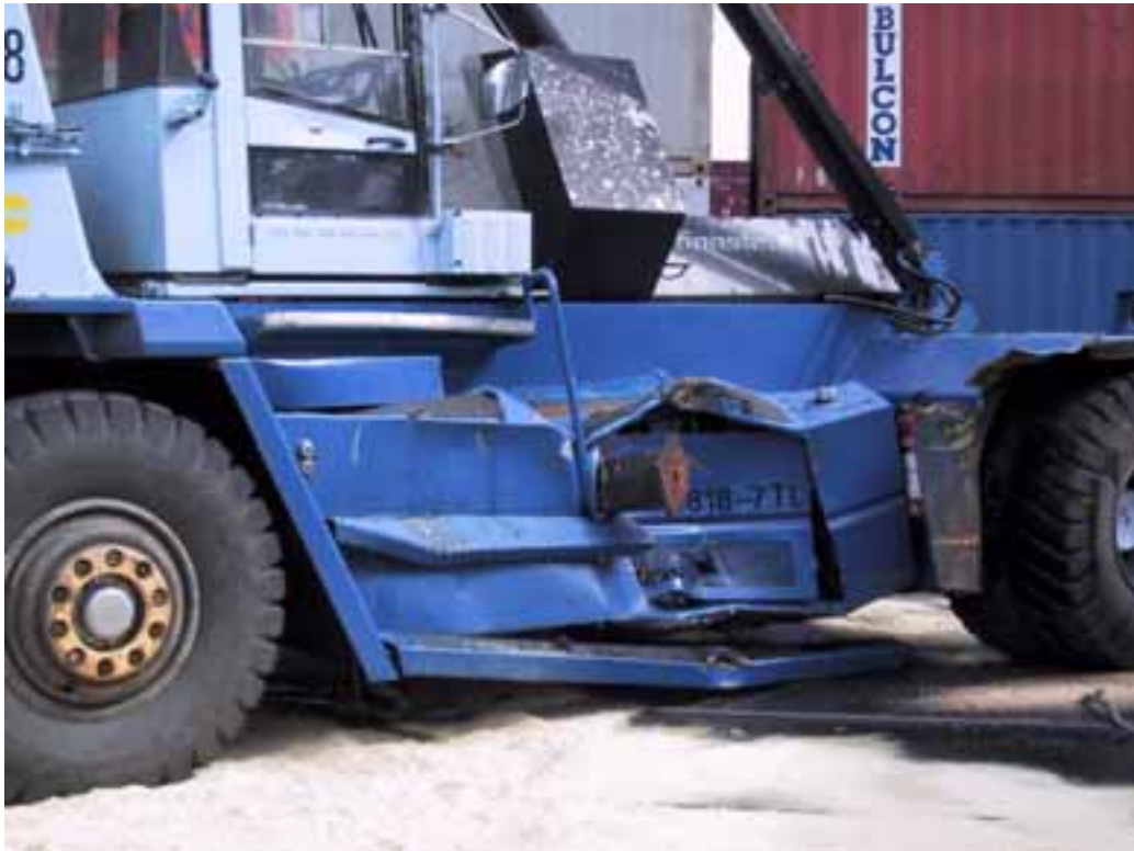
Kuva 3. Kuva kurottajan vaurioista. Veturista irronnut puskin jäi kiinni kurottajan kylkeen.
