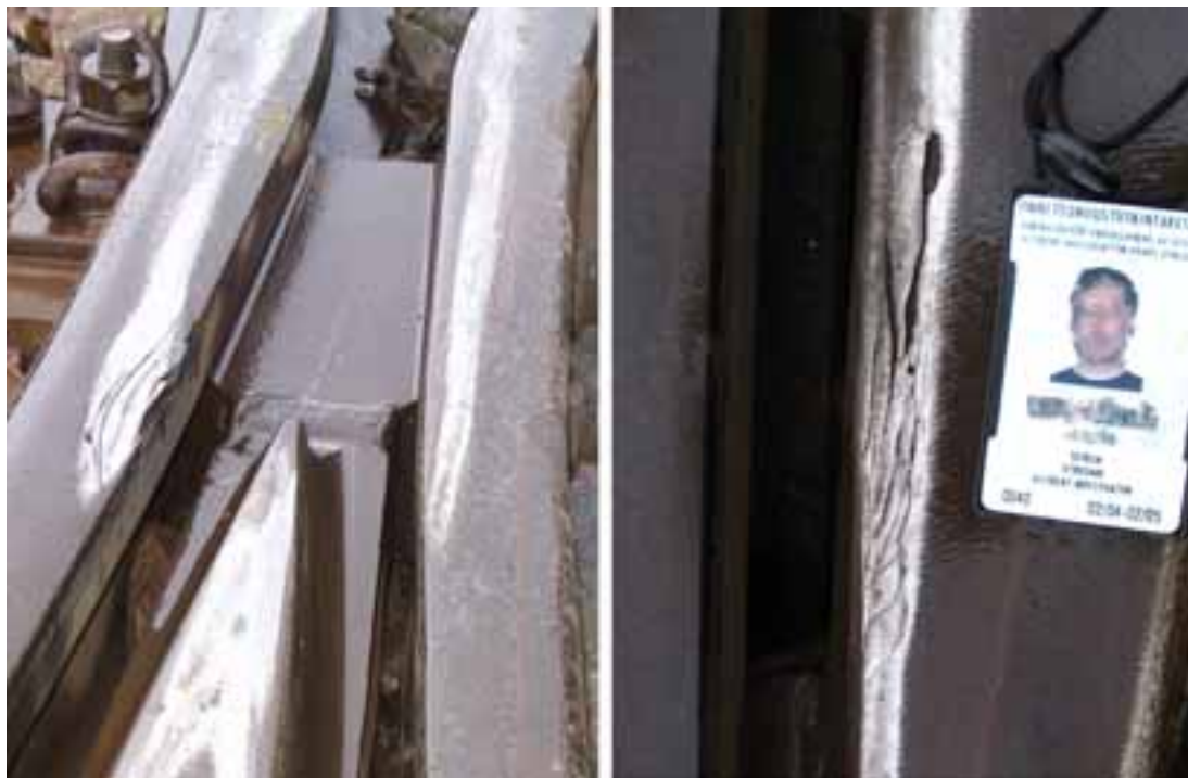
Kuva 6. Kiskoissa havaitut iskeymäjäljet.
