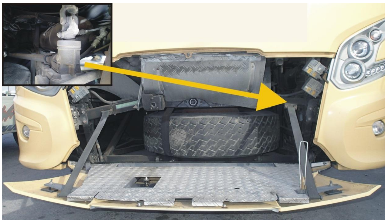
Bild 9. Framdelens strukturer och styrväxelns placering hos en buss av samma typ.
