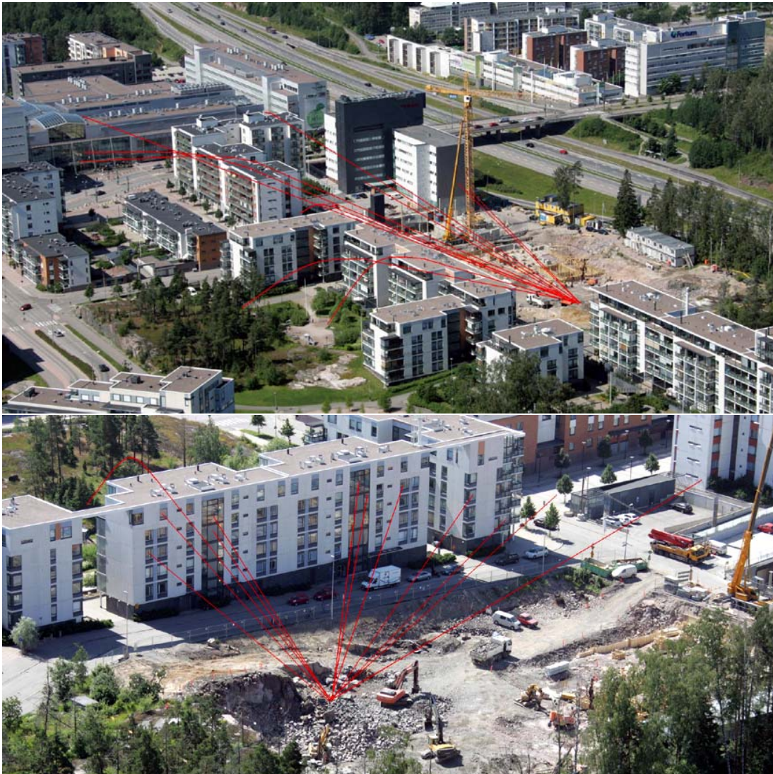
Kuva 2. Räjähdyksessä lentäneiden kivien lentoratoja. (Kuva: Rajavartiolaitos, piirros: poliisi.)
