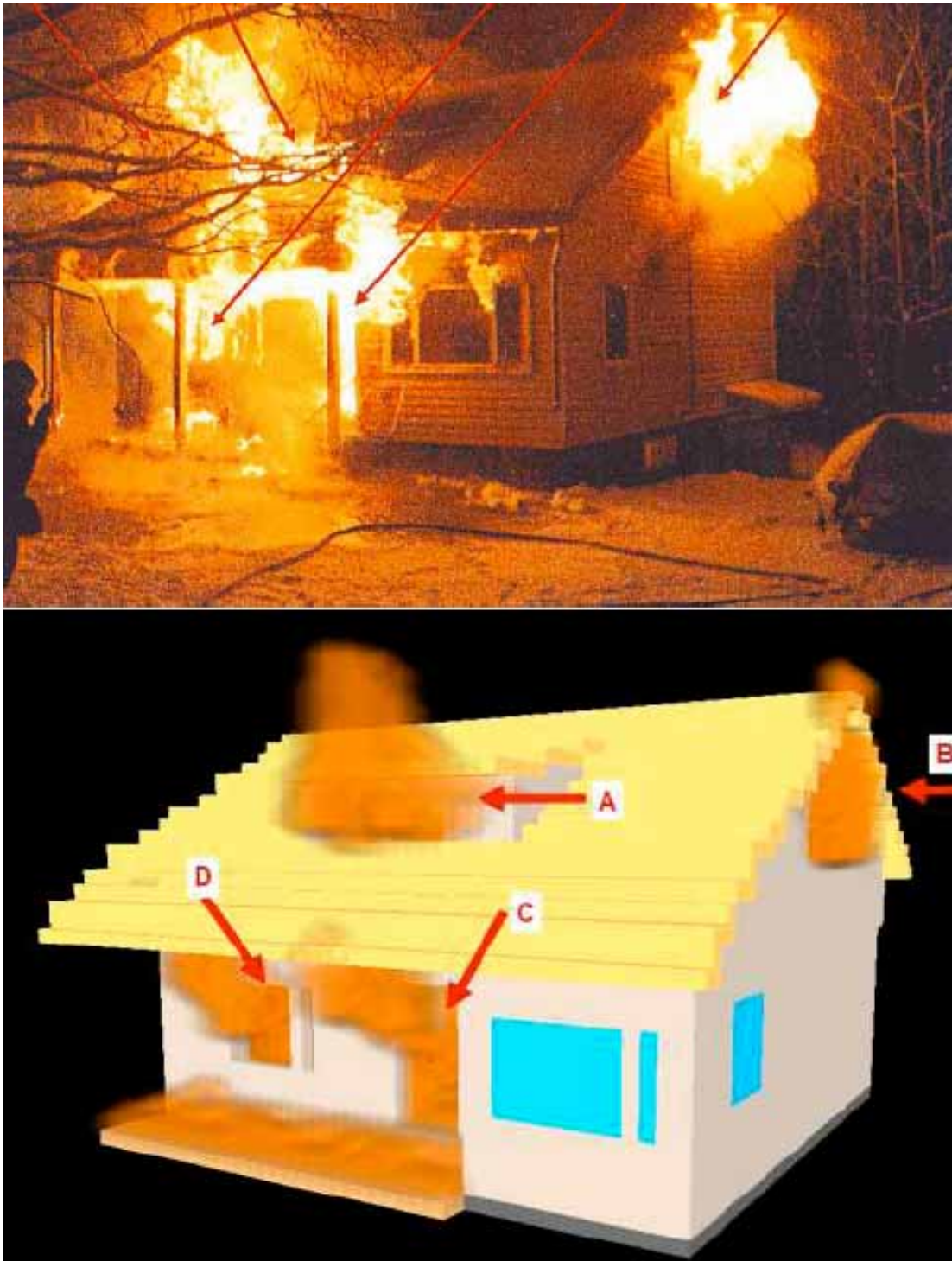
Kuva 10. Simuloinnissa saadun kuvan ja paikalle ensimmäisenä saapuneiden viranomaisten valokuvan vertailu. Simuloinnissa saadut tulokset näyttävät toistavan hyvin todellista tilannetta ja palossa toteutuneita vaurioita.
