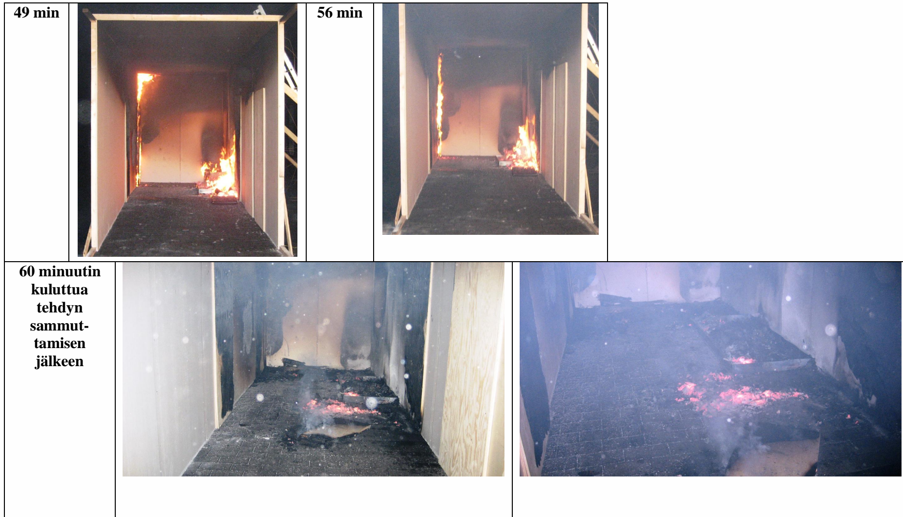
Kuva 21. Palon kehittyminen aikana 49-56 minuuttia. Sammutus tehtiin 60 minuutin palon jälkeen.
