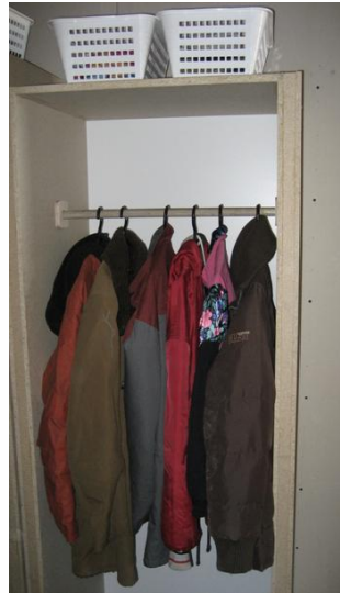
Kuva 6. Pitkäniemen sairaalan tulipalon rekonstruointikokeen takkien ja muun vaatetuksen sijoittelu lastulevykaapeissa: a) molemmat kaapit ja b) yksityiskohta matalammasta kaapista.
