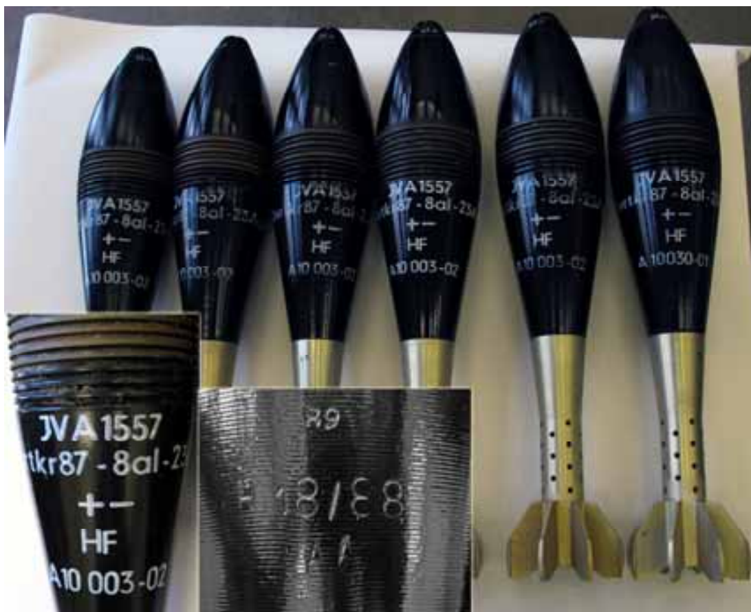
Kuva 10. Valurautainen kranaatti JVA 1557. Onnettomuusheittimeltä jäljelle jääneet ammuksset.
