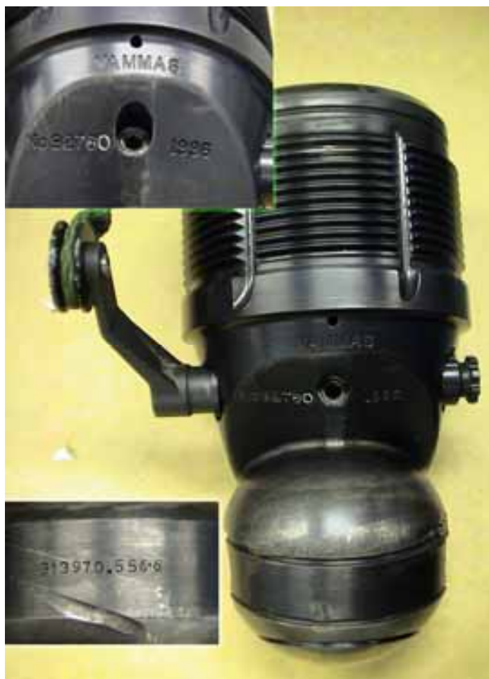
Kuva 9. Onnettomuusheittimen peräkappaleen merkinnät. Heittimen sarjanumero on 92760, valmistettu vuonna 1996, valmistaja Vammas Oy, raaka-ainenumero 313970.556.6.
