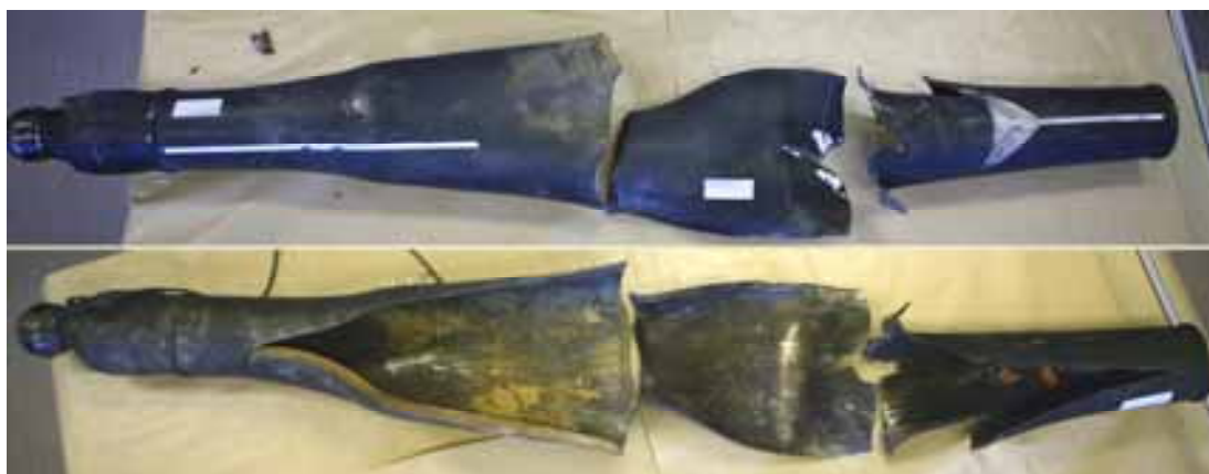
Kuva 14. Kranaatinheittimen rikkoutuneen putken osat eri puolilta kuvattuna. Putken pituus on peräkappale mukaan luettuna 2 154 mm.
