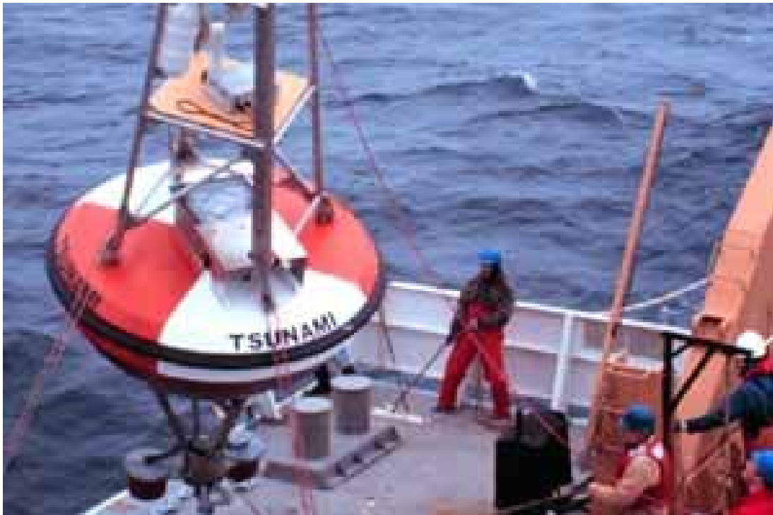
Bild 5. En av tsunamivarningssystemets bojar installeras i Stilla havet. (Foto NOAA)
