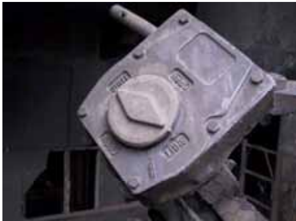
Kuva 13. Palaneen venttiilin vaihte palopaikalla kuvattuna. Käsipyörän sokka on katkennut ja hieman esillä.
