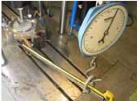
Kuva 19. Kuormituskokeen järjestely kuormanalaisen läpän liikuttelumomentin mittaamiseksi.
