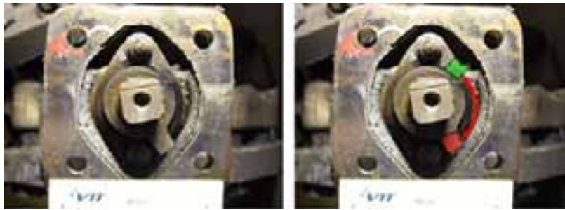
Kuva 16. Vaihteen kiinnityslaippa venttiilirungossa. Akselilla oleva rengas alaoikealle sojottavine nokkineen on läpän liikerajoitin, jonka lukkoruuvi puuttuu tyystin. Puuttuminen ei vaikuta venttiilin läpän toiminnan ääriasentoihin sillä myös vaihteessa on rajoittimet. Mikäli akselin rajoitin juuttuu akselille tässä väärässä asennossa voi rajoitin aiheuttaa venttiilin jumittumista sitä avattaessa (kuvassa vastapäivään), sillä nokka törmää tällöin laipan sisäpuoliseen reunaan ja voisi kiilautumalla tätä vasten aiheuttaa jumittamista.
