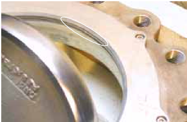
Kuva 18. Venttiilin 77113 1001 0110 085685 01 tiiviste, jonka tulipalotiivisteessä (FS- eli "fire safe") on poimuttunut alue, jossa mahdollisesti vaaleita jälkiä hankauksesta poimujen harjoilla. Poimun jakso 13 mm, joka on sama kuin palaneen venttiilin läpän reunassa olevien kiinnipalaneiden kokkareiden välimatka.
