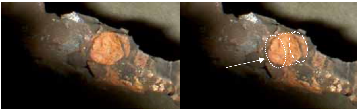
Kuva 9. Läpän toisioakseli, jonka laakeriholkista on eniten palanut se sektori, jolle akseli vierii avaamisen alkuvaiheessa ennen kuin liukumisen alkaa. Mittanuolen kohdalla akselin palaneen reunan lyhin etäisyys rungon aksiaalilaakerointipintaan on 90 mm, mikä merkitsee sitä, että 25 mm leveä laakeriholkki on viivan jatkeelta palanut. Akselin kohtisuoraa poikkipintaa kuvaavat ellipsit on sijoitettu kuvaamaan osittain palanutta laakeriholkkia.
