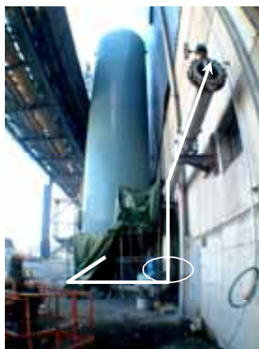
Kuva 23. Puhalluskoelaitteisto Torniossa. Testattava venttiili alhaalla kuvassa hieman oikealla ympyröitynä valkoisella. Valkoinen nuoleen päättävä murtoviiva osoittaa putkistoa, joka lähtee sinisestä paineilmasäiliöstä. Järjestelmässä on lähtöventtiili, koeventtiili sekä loppusulkuventtiili.
