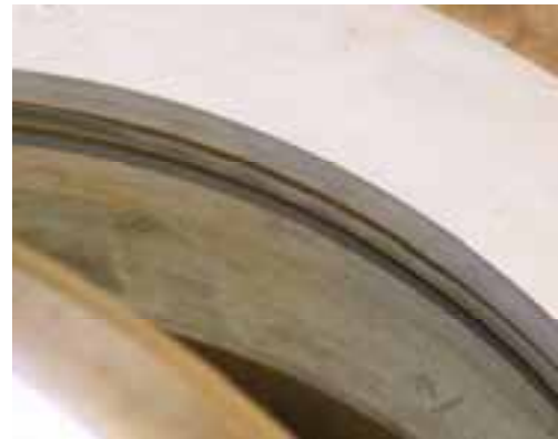
Kuva 18. Venttiilin 77113 1001 0110 085685 01 tiiviste, jonka tulipalotiivisteessä (FS- eli "fire safe") on poimuttunut alue, jossa mahdollisesti vaaleita jälkiä hankauksesta poimujen harjoilla. Poimun jakso 13 mm, joka on sama kuin palaneen venttiilin läpän reunassa olevien kiinnipalaneiden kokkareiden välimatka.
