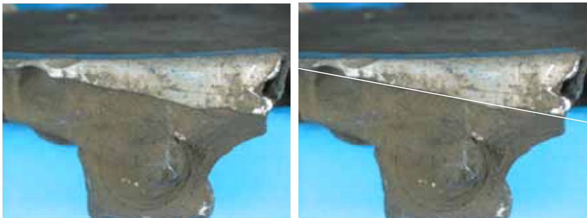
Kuva 12. Läpän reuna käyttävän vaihteen eli ensiöakselin puolella. Reunassa kiinnipalanutta ainesta ja tumma viiru. Kiinnipalaneita kokkareita kahdessa sarjassa, kummassakin kokkareiden etäisyys vastaa FS-tiivisteiden poimujen jaksoa (luku 6.2.1).
