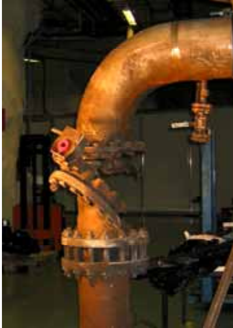
Kuva 2. VTT:lle toimitetun palaneen venttiilin (sarjanumero: 77113 1001 0110.085685.02) ja putkiston osat koottuna. Oikeassa kuvassa läpän asennon muovinen osoitin vielä paikallaan, vasemmassa kuvassa poistettu. Vaihteen käsipyörä puuttuu.
