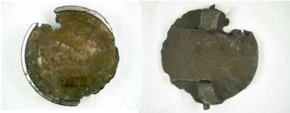
Kuva 7. Palaneen venttiilin läppä päältä (vasemmalla) ja alaspäin (oikealla). Akselit pystysuunnassa. Kuvassa vasemmalla "päältä" läpän oikeanpuoleinen, myötävirtaan siirtynyt tiivistyspinta palanut, vasemmanpuoleinen vastavirtaan noussut tiivistyspinta palanut vain niissä sektoreissa, jotka ovat olleet tiivistettä vasten. Suurimpien palovaurioiden kohdalla, eli sektoreissa 15-16 ja 9-10 on vaikuttanut voimakas rakovirtaus, samalla kun raon toisella reunalla on ollut PTFE tiiviste. Läpän tiivistyspinta on miltei vaurioitumaton sektorissa 11-14, joka on sijainnut tiivisteestä hapen tulosuuntaan. Tiivisteestä hapen menosuuntaan oleva tiivistyspinta, joka on ollut suurelta osin palaneen PTFE tiivisteiden palon vaikutusalueella on tyystin palanut sektorissa 2-8, suurimman palovaurion sijaitessa toisioakselin (eli "vapaan") tuntumassa, vasemman kuvan oikea "alanurkka".
