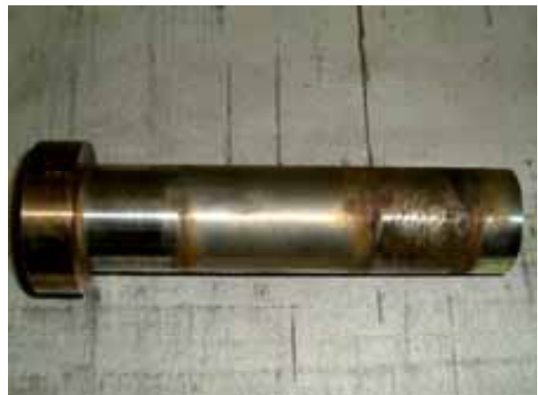
Kuva 21. Sahaamalla avatun venttiilin toisioakselin ensiösäteislaakerin holkki ja akseli. Laakeri vioittunut ja akseli likainen. Akselin ulkopäässä vasemmalla päälle kutistettu aksiaalilaakerin holkki.
