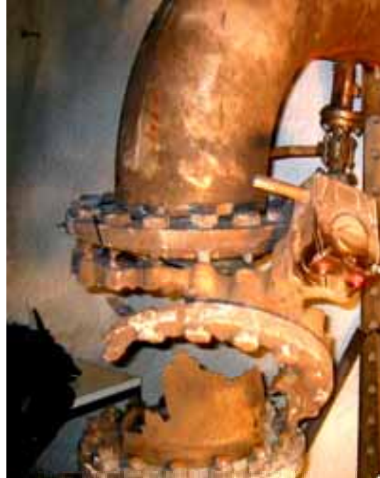
Kuva 2. VTT:lle toimitetun palaneen venttiilin (sarjanumero: 77113 1001 0110.085685.02) ja putkiston osat koottuna. Oikeassa kuvassa läpän asennon muovinen osoitin vielä paikallaan, vasemmassa kuvassa poistettu. Vaihteen käsipyörä puuttuu.
