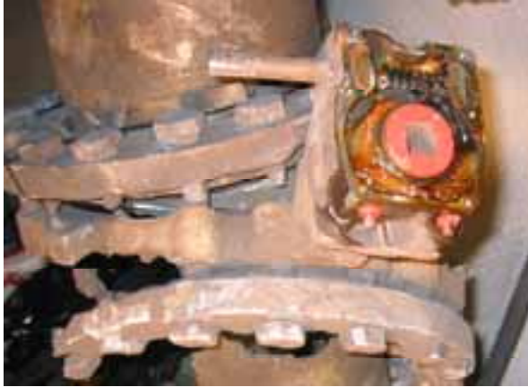
Kuva 15. Venttiilin käyttövaihte kansi avattuna. Voitelu näyttää toimineen.
