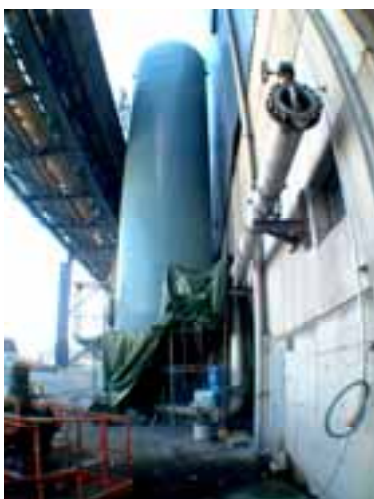
Kuva 23. Puhalluskoelaitteisto Torniossa. Testattava venttiili alhaalla kuvassa hieman oikealla ympyröitynä valkoisella. Valkoinen nuoleen päättävä murtoviiva osoittaa putkistoa, joka lähtee sinisestä paineilmasäiliöstä. Järjestelmässä on lähtöventtiili, koeventtiili sekä loppusulkuventtiili.
