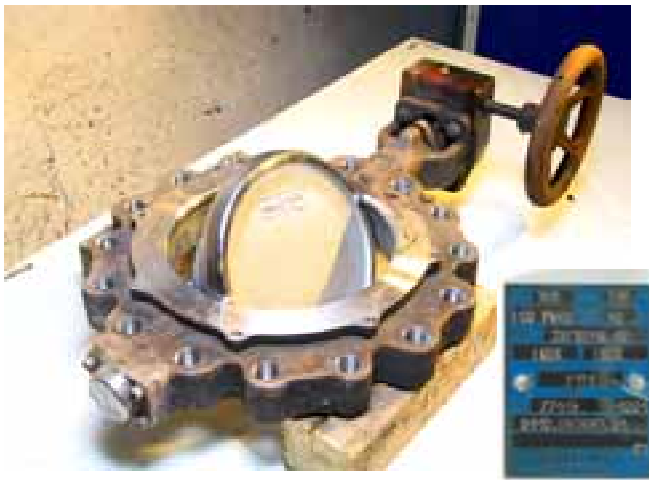
Kuva 3. Palaneen kanssa samanlainen perhosventtiili 1001 0110 085685.01. Tämä on ilmeisesti sarjassa palanutta edeltävä. Irrotettu palolinjasta palopaikan alavirralla noin 15 metrin etäisyydeltä palaneesta. Tyypikilpi toisesta samanlaisesta venttiilistä oikealla.
