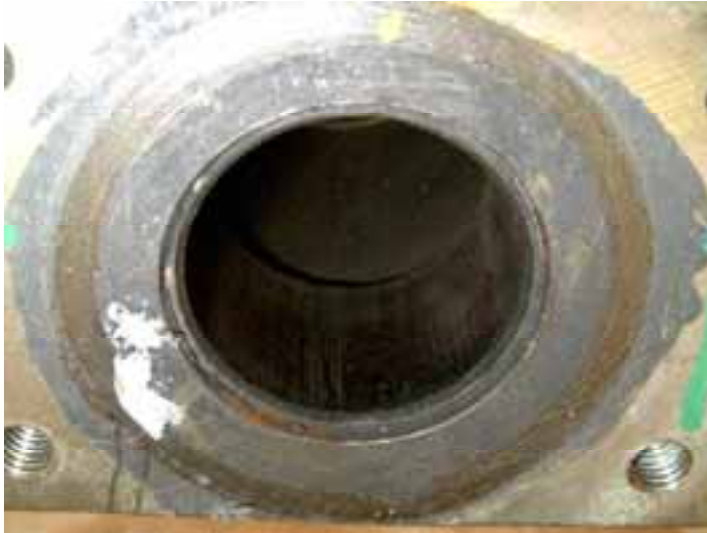
Kuva 22. Venttiilin toisioakselin ulompi säteislaakeri eli tukiholkki, jonka liukupinnoite on kunnossa. Ensioakselin laakeriholkki on rakenteeltaan samanlainen.
