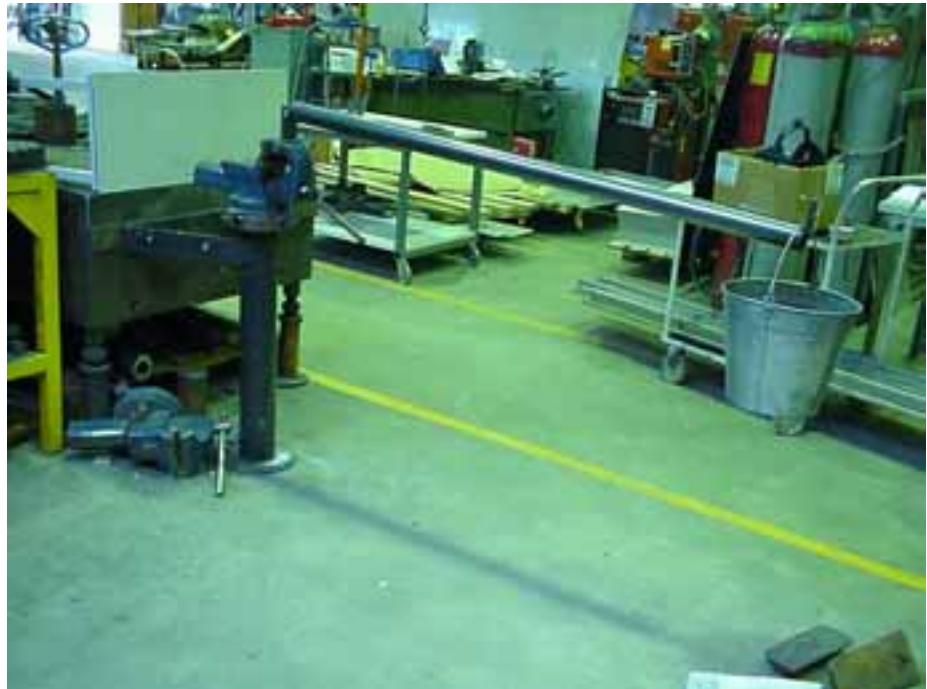
Kuva 1. Hitsauskoeliitoksen murtokoelaitteisto. Testattava koepala vasemmalla kiinnitettynä ruuvipenkkiin. Putkesta valmistetun kuormitusvivun päässä sanko painojen lisäämistä varten.
