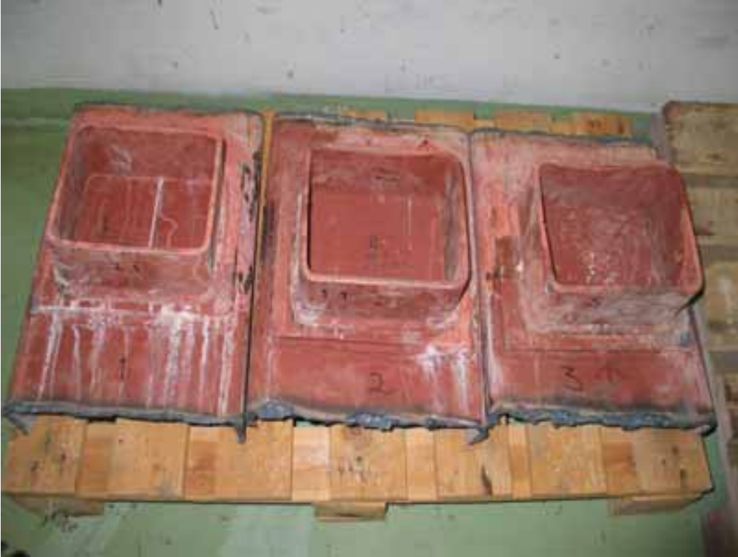
Kuva 1. Murtuneet pystypalkit 1, 2 ja 3 ja niitä vastaavat vaakapalkin kannakkeet 2.1, 1.1 ja 3.
