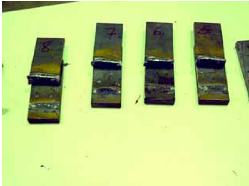
Kuva 3. Väärällä polttimen asennolla hitsatut koepalat kuormituksen jälkeen. Kuormankantokyky vain murto-osa koepalojen 1, 2, 3 ja 4 rajakuormituksesta.
