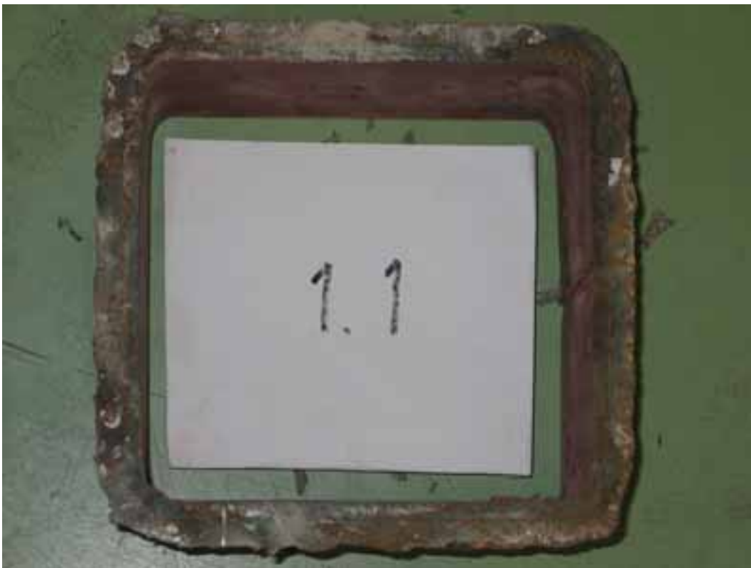
Kuvat 7 ja 8. Pystypalkin 2 murtopinnat.
