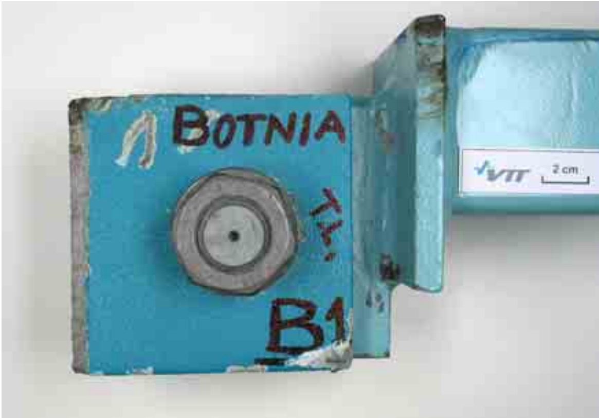
Kuva 1. Näytteeksi saatu korvake B1 ja siihen liitetty neliöputki. Korvakkeen yläreuna on kuvassa alhaalla.
