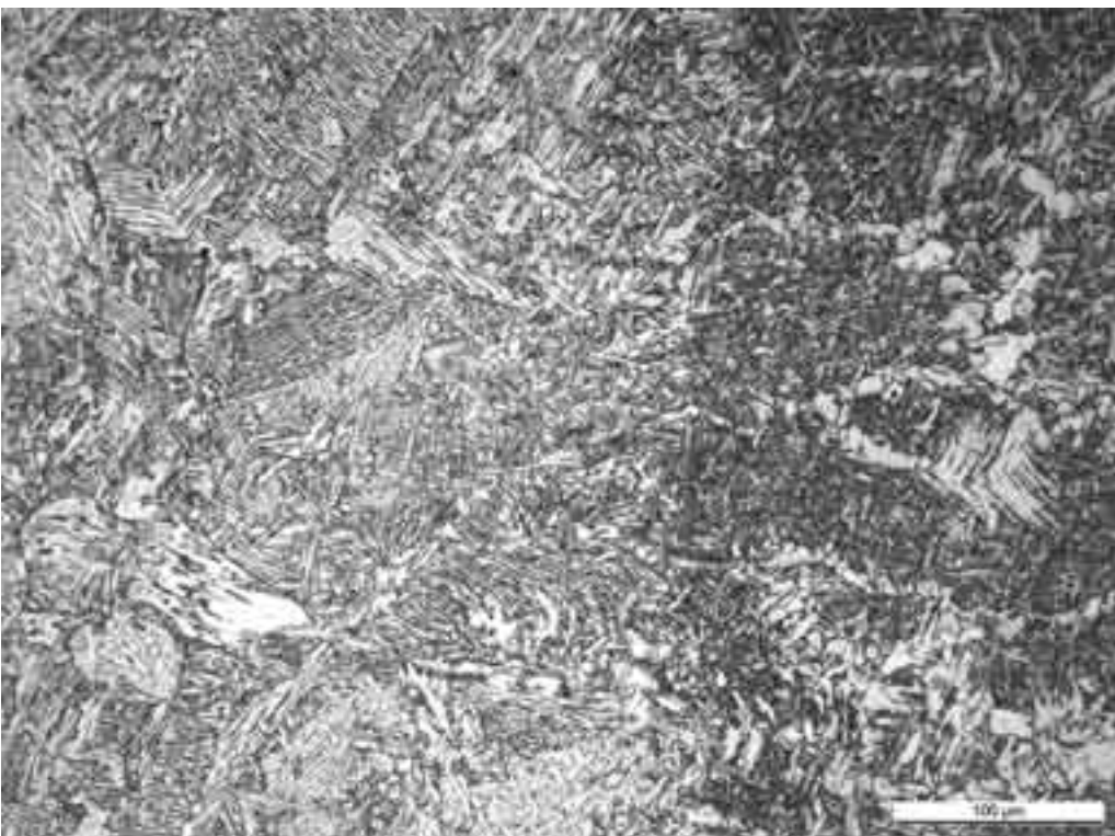
Kuva 19. Sularajan poikkileikkaus. Hitsiaine on kuvassa oikealla ja muutosvyöhyke vasemmalla.
