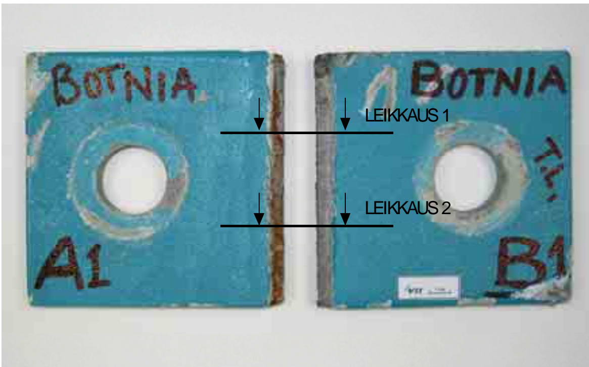
Kuva 2. Korvakkeen A ja B sivut A1 ja B1. Poikkileikkausnäytteiden irrotuskohdat on merkitty nuolella.
