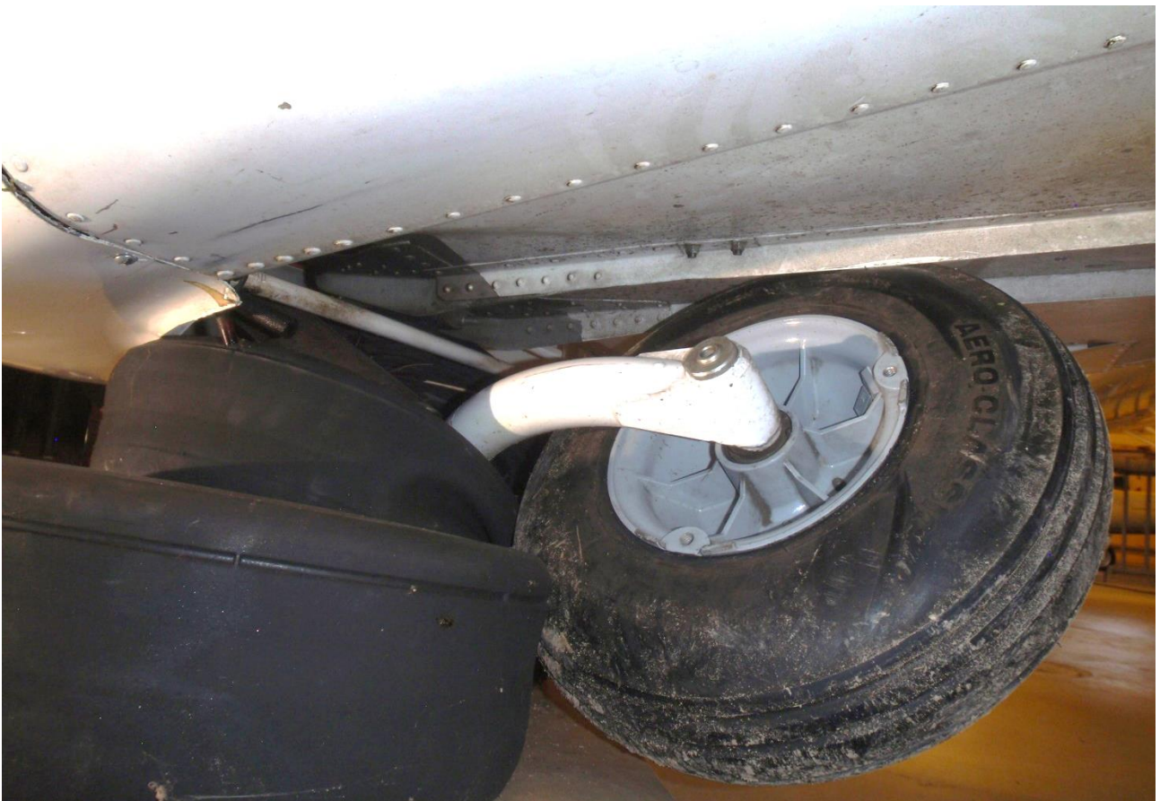
Bild 5. Nosstället har vekt sig och vridit sig åt vänster. (Bild: OTKES)
