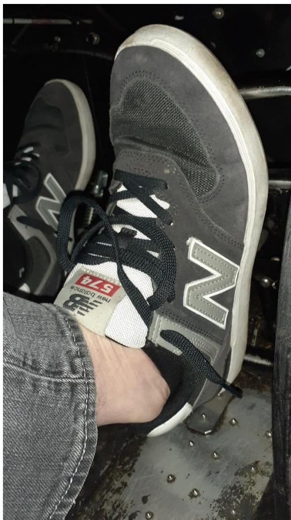
Bild 7. I bilden har den vänstra pedalen tryckts i botten. Till exempel i en sådan här situation är vinkeln av den högra pedalen sådan att en lång person kan oavsiktligt trycka på den högra pedalens tåbroms. (Bild: OTKES)
