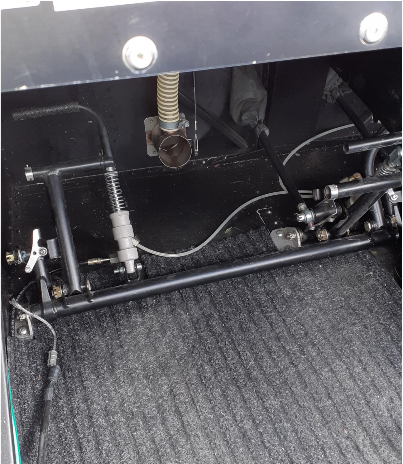
Bild 3. Den vänstra pedalen var tryckt ned mer än normalt. Sidrodrets vajer bredvid pedalen hade lossnat. (Bild: OTKES)
