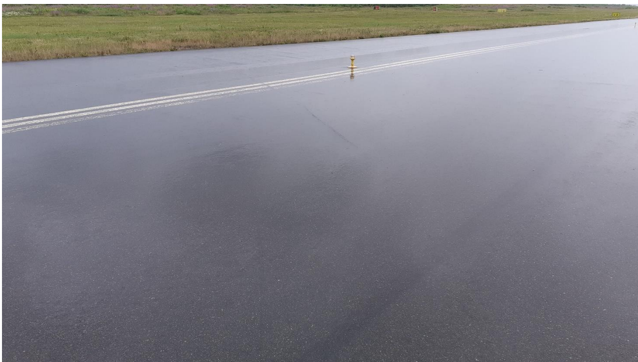
Bild 1. Spår efter huvudställets däck vid sidan om startbanan. Bilden är tagen efter olyckan, det regnade vid tillfället. Det regnade inte när olyckan inträffade. (Bild: OTKES)
