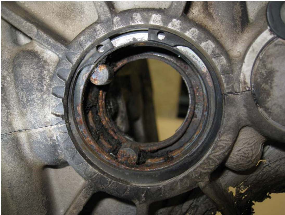
Kuva 6. Hammaspyörän jäljet OH-U541:n Rotax 912 -moottorin kampikammion etuseinässä.
