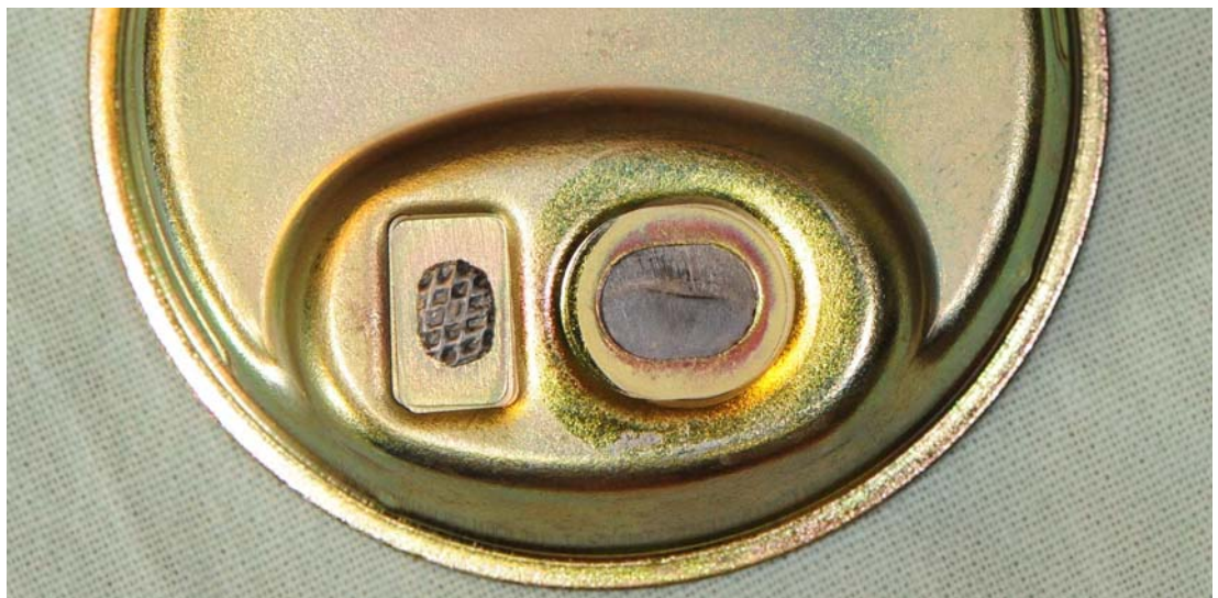
Kuva 3. Venttiilinläpän pinnassa on nähtävissä selkeät sivusuuntaiset kulumisurat, joista päätellen läppä on liikkunut jatkuvasti kiinniasennon ja puoliksi auki asennon välillä.
