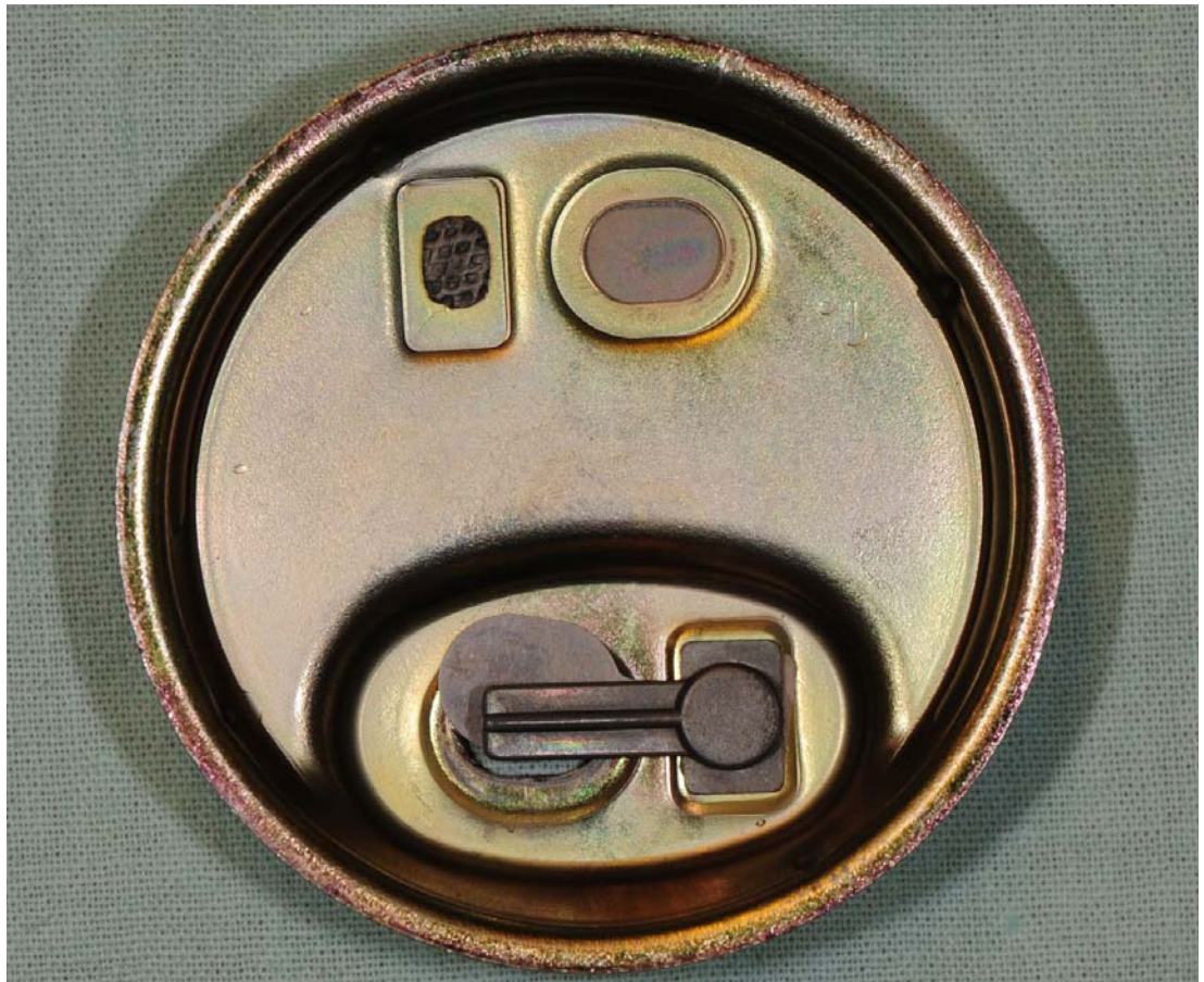
Kuva 2. Imuventtiilin läppä kääntyneenä osittain pois paikaltaan.
