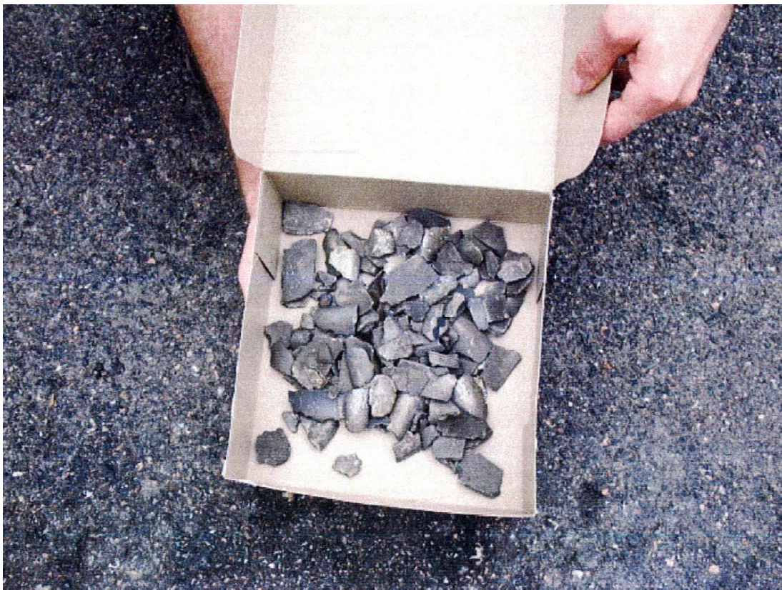
Kuva 4. Kunnossapitoyksikön kiitotieltä 22R löytämät moottorin osat. Taustalla näkyy kiitotien pintaa.
