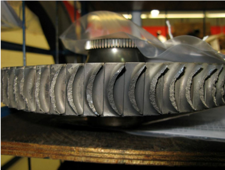
Kuva 8. Turpiinin kolmannen vyöhykkeen ylikuormasta aiheutunut kaikkien siipien murtuma.
