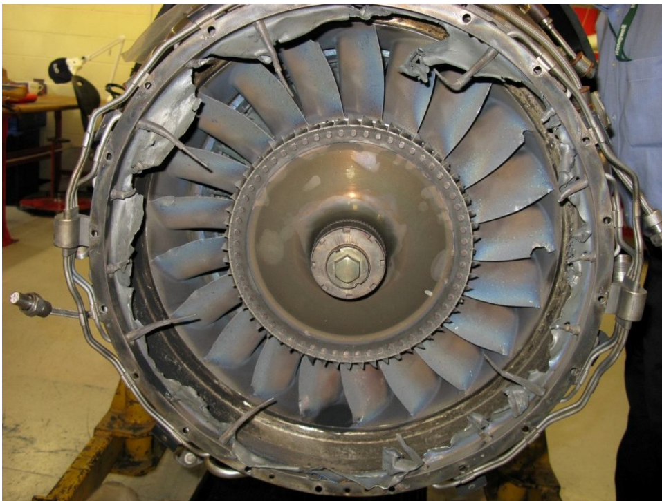
Kuva 9. Turpiinin neljännen vyöhykkeen vauriot, jotka ovat syntyneet turpiinin siipien irtoamisen takia. Suihkuputken kehys on sulanut mutta kokonainen. EGT-anturit ovat vääntyneet.
