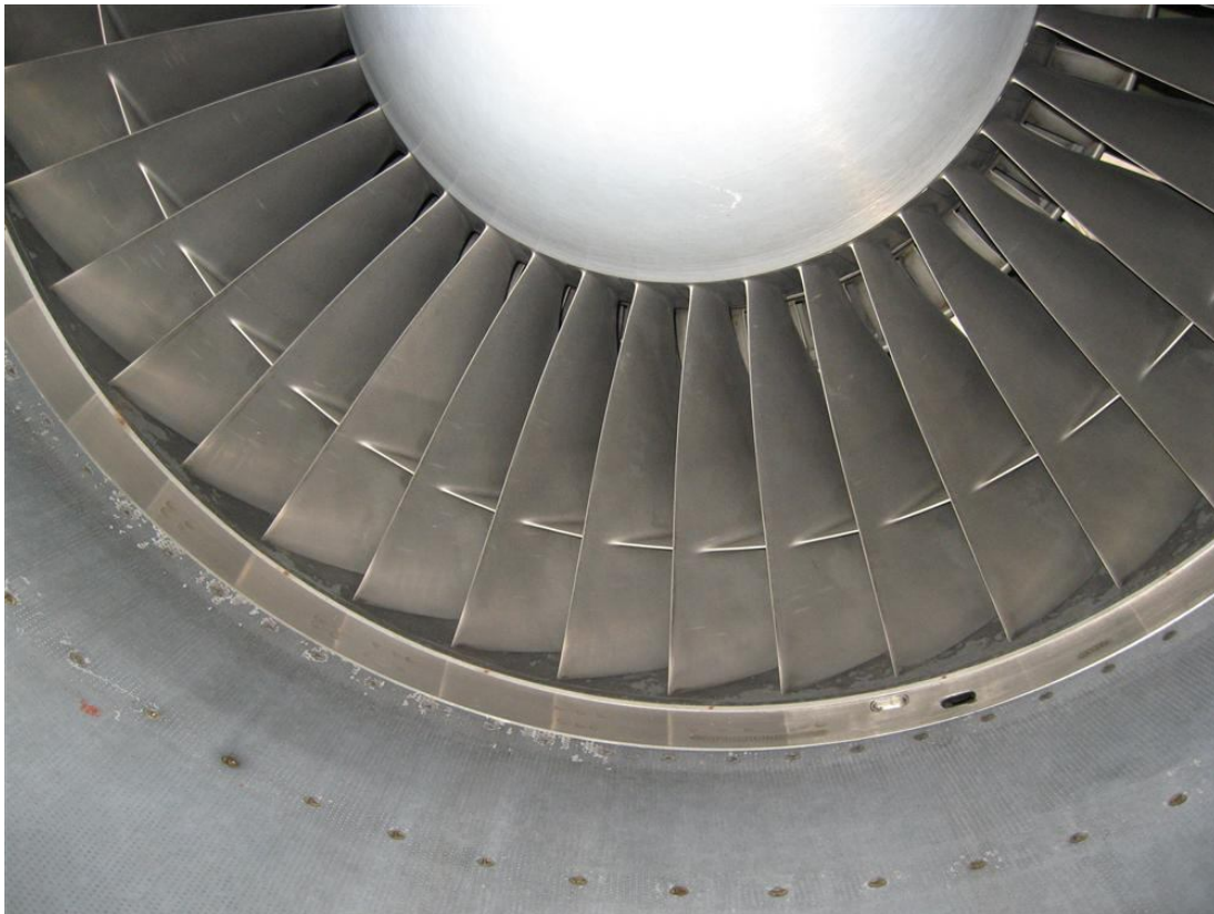
Kuva 6. Vaurioitunut 1-moottori edestäpäin tapahtuman jälkeen.
